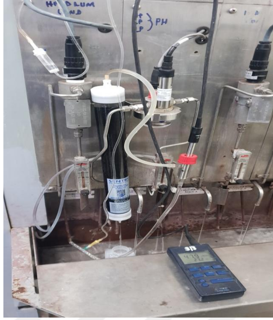
Şekil 2.5. Drumlardan gelen suya bağlanmış aquamandix reçine kolonu
