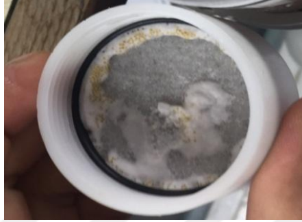
Şekil 3.2. Laboratuvarda yapılan testte çökelen fosfat tuzları
