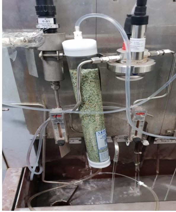
Şekil 2.4. Drumlardan gelen suya bağlanmış zeolit reçine kolonu
