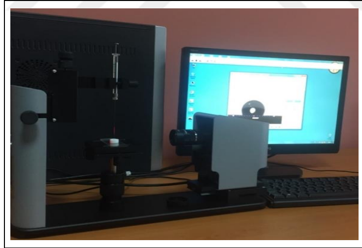
Şekil 3.7. Theta Lite temas açısı ölçüm cihazı
