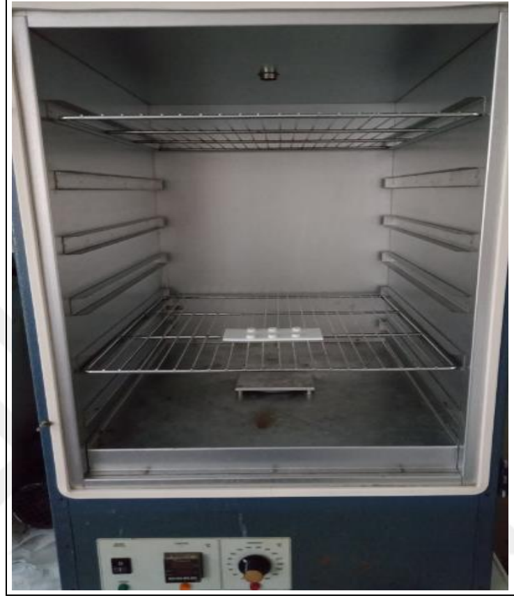
Şekil 3.3. Etüvede teflon plaka üzerine yerleştirilerek sinterleme prosesinden geçirilen UHMWPE/Selüloz ve UHMWPE/Selüloz/PE-g-MA kompozit peletleri
