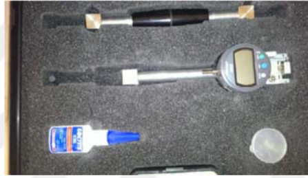
Şekil 2.19. Sökülebilir mekanik deformasyon ölçer (DEMEC)
