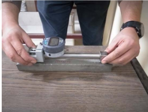
Şekil 4.16. Uzun dönemli büzülme okuması (ASTM C-531)
