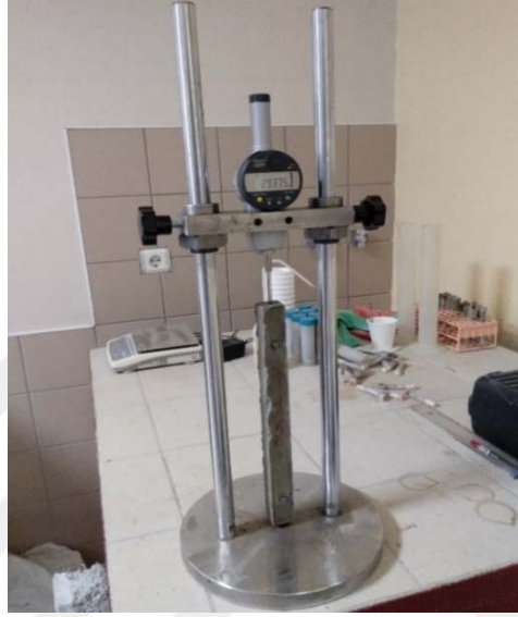
Şekil 4.12. Uzun dönemli büzülme okuması (ASTM C-157)
