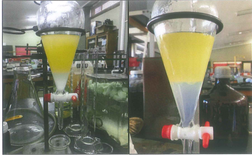
Şekil 2.20 (a) Distile su ile yıkama, (b) nitrik asit çözeltisi ile yıkama
