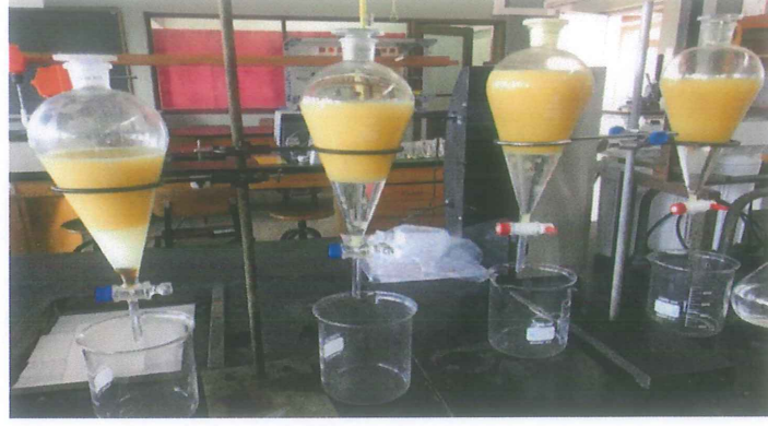
Şekil 2.5. Ayırma hunisine alınan yağ örneklerine uygulanan yıkama prosesi
