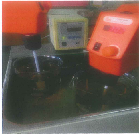
Şekil 2.2. Su yataklı kesikli reaktörde reçine giderme işlemi
