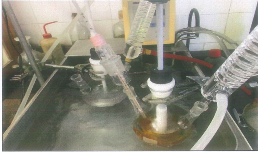
Şekil 2.13. Kesikli reaktör içerisinde transesterifikasyon reaksiyonu
