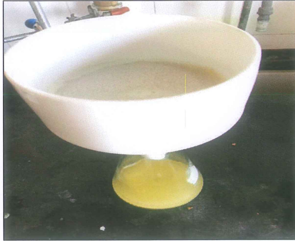
Şekil 2.16. Vakum filtrasyon ile ayırma işlemi
