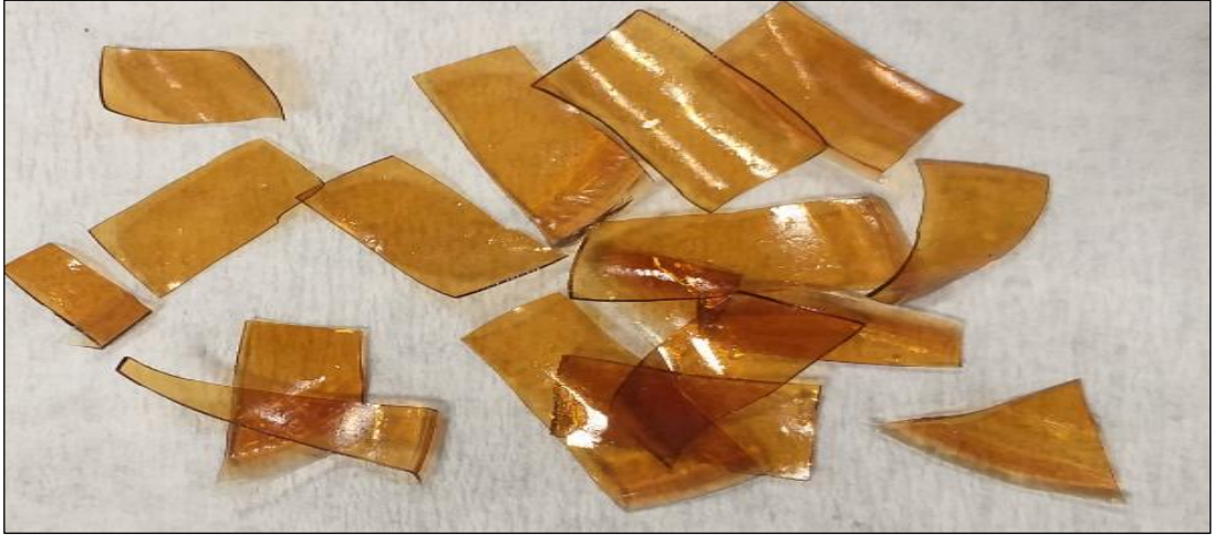
Şekil 3.4. Kesikli reaktörde kullanılan katalitik membran
