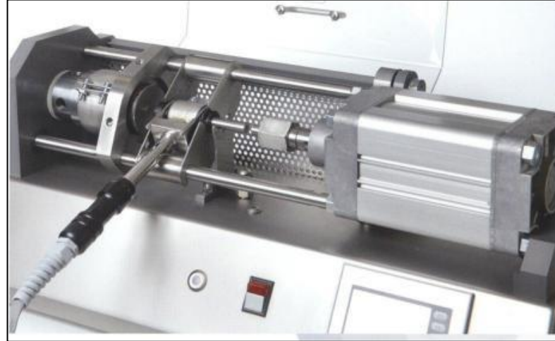
Şekil 3.8. Laboratuvar tipi enjeksiyonla kalıplama cihazı
