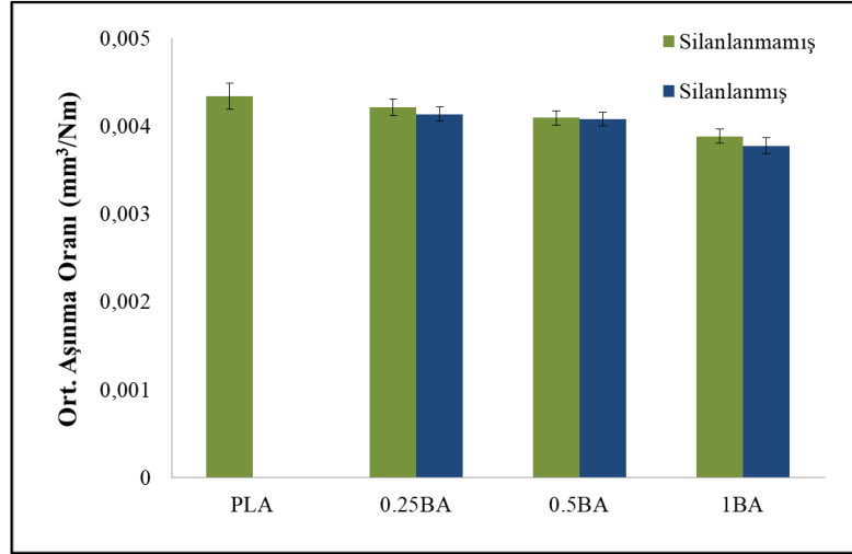
Şekil 4.54. Borik asit takviyeli kompozitlerin ortalama aşınma oranları
