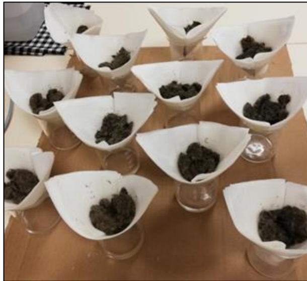
Şekil 3.6. Bazalt elyafın silanlama sonrası süzülmesi
