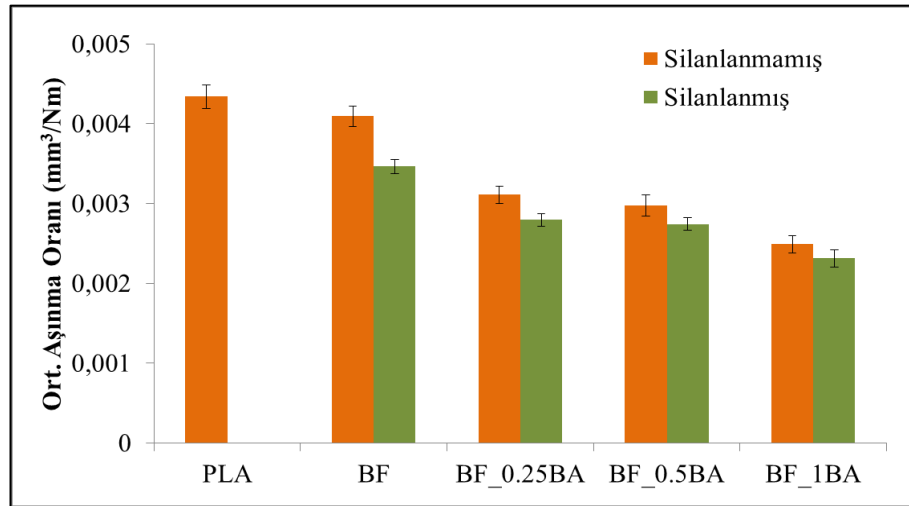
Şekil 4.68. Bazalt elyaf ve borik asit içeren hibrit kompozitlerin ortalama aşınma oranları
