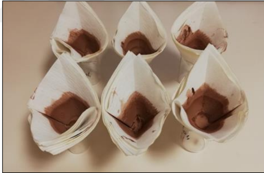
Şekil 3.3. Silanlanmış pomza partiküllerinin kurutulması
