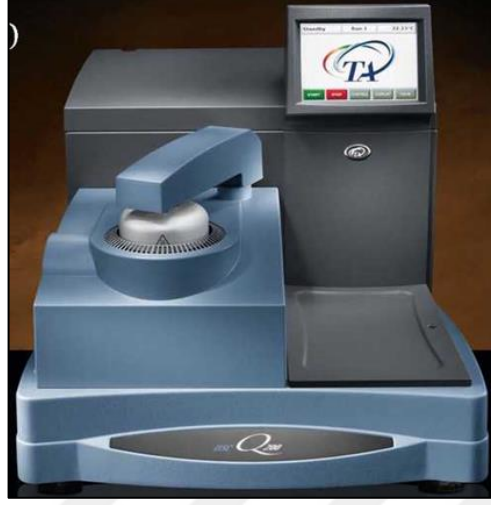
Şekil 3.18. “TA Instruments-Q200” model DSC analiz cihazı
