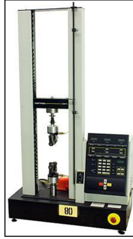
Şekil 3.14. “Instron marka 4411 model” çekme test cihazı
