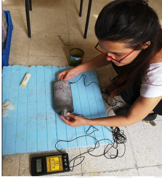
Şekil 3.9. Beton numunelerinin ultrason cihazı ile ölçümü
