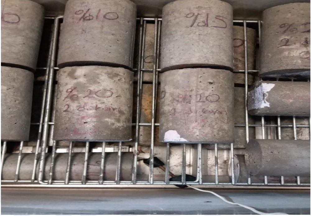
Şekil A.3. Donma çözünme testi için hazırlanan referans numunenin gösterimi
