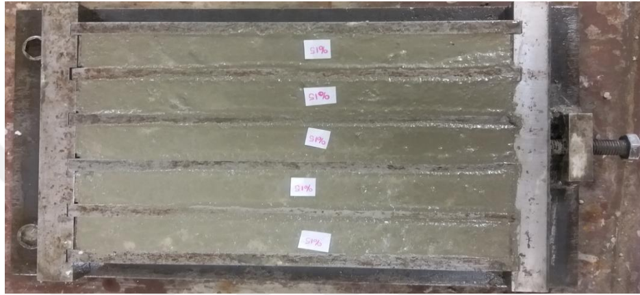
Şekil 3.10. Sülfata karşı dayanıklılık deneyi için hazırlanan harç çubuklar
