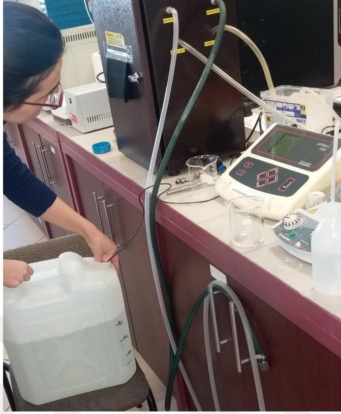
Şekil 3.15. Sodyum sülfat çözeltisinin pH değerinin ölçülmesi
