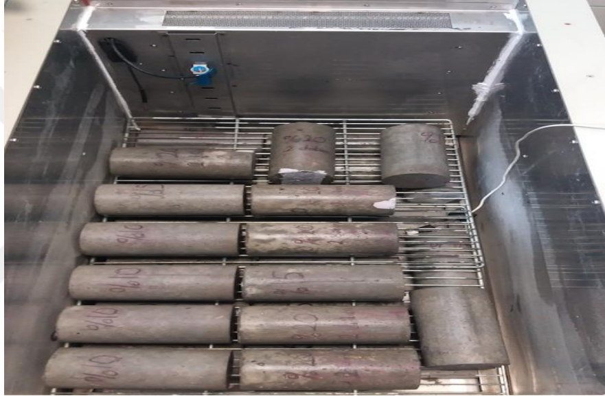
Şekil 3.7. Donma çözünme test cihazına numunelerin yerleşimi
