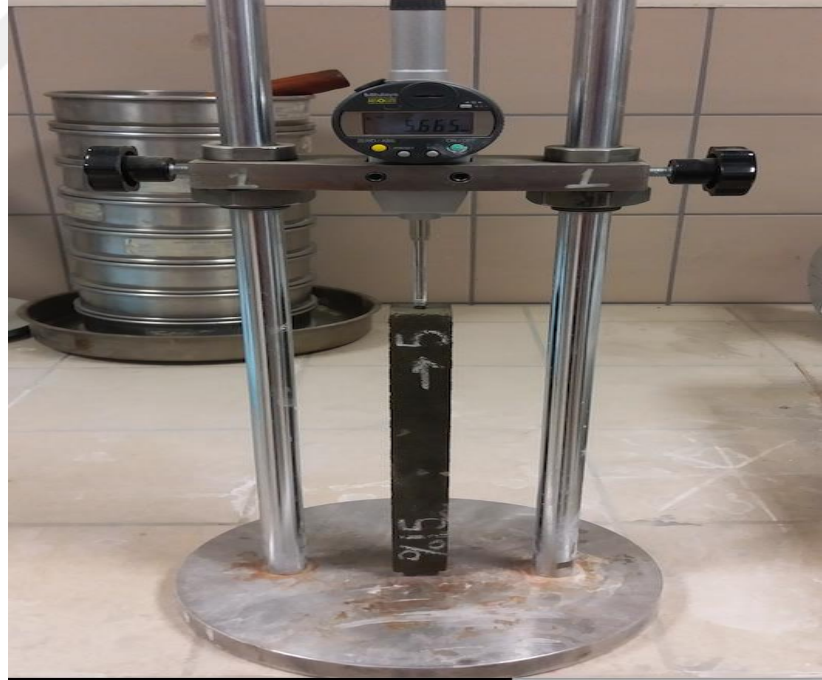
Şekil 3.14. Harç çubuklarının komperatör yardımıyla ölçülmesi
