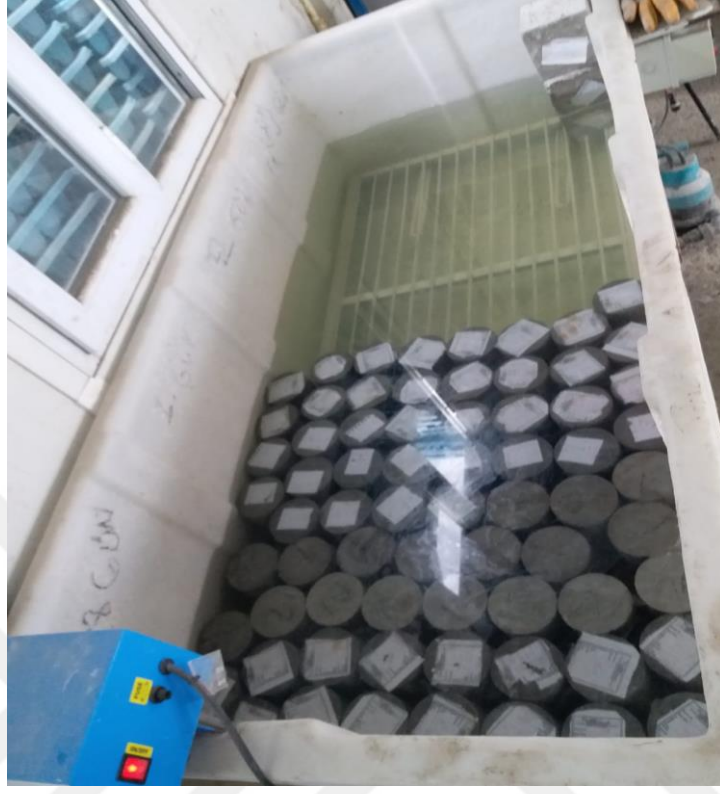
Şekil A.1. Kür havuzunda bekletilen silindir numuneler
