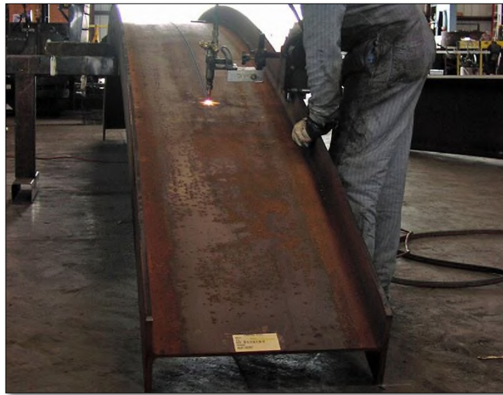
Şekil 1.1. I-kesitli profilin gövdesinden kesilmesiyle T-kesitli profil elde edilmesi[1]
