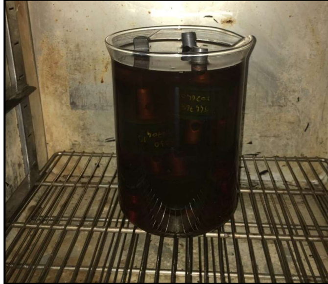
Şekil 2.3. Yağ ortamında yaşlandırılmış numuneler
