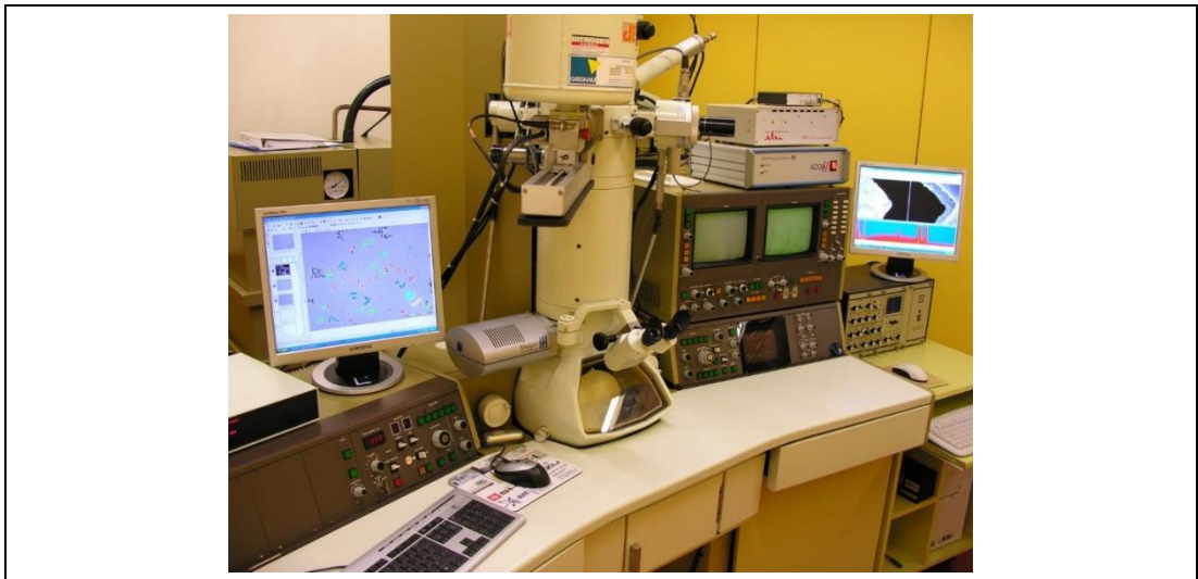
Şekil 6.31. Jeol JEM 2000FX STEM üzerine takılı EDS (IXRF Systems) ve Olympus SIS görüntü analiz sistemi
