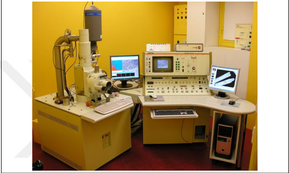
Şekil 6.30. Jeol JSM 840A SEM üzerine takılı EDS (IXRF Systems) ve Olympus SIS görüntü analiz sistemi
