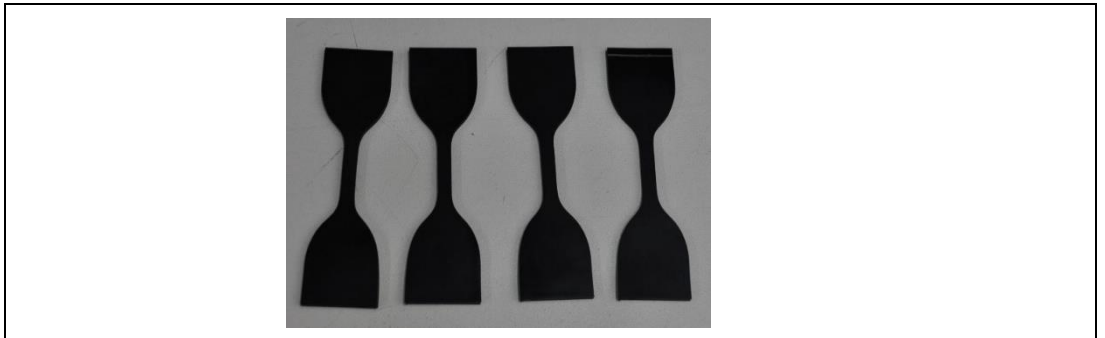
Şekil 6.17. Tensometre örnekleri (uzunluk: 100 mm, orta genişlik: 5 mm, kalınlık~2 mm)
