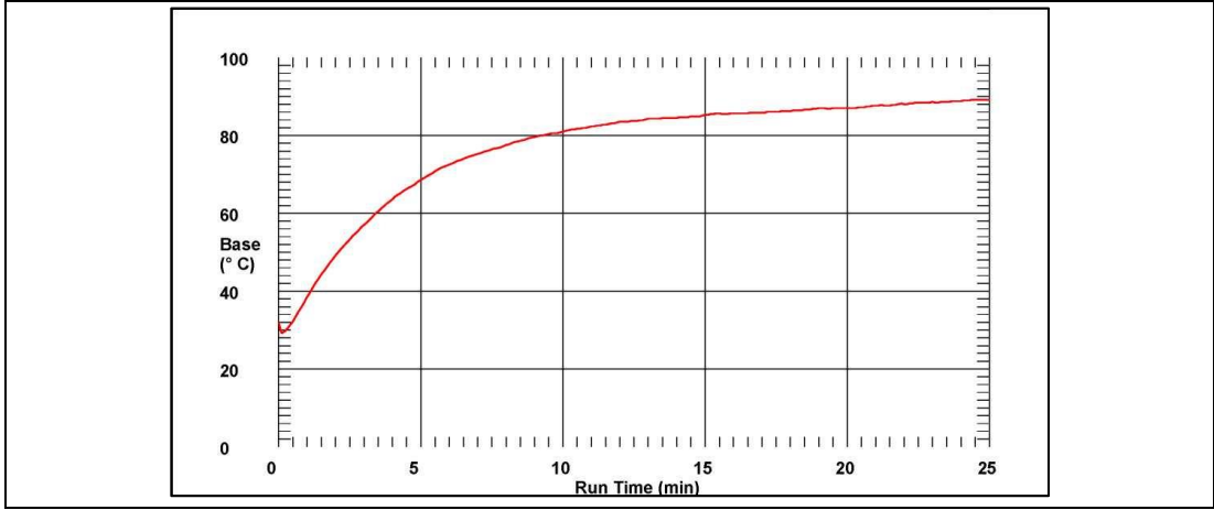
Şekil 7.34. 5C3A örneği ısı üretim grafiği
