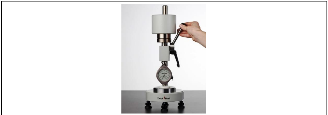
Şekil 6.21. Sertlik ölçüm cihazı Zwick/Roell (Shore A)
