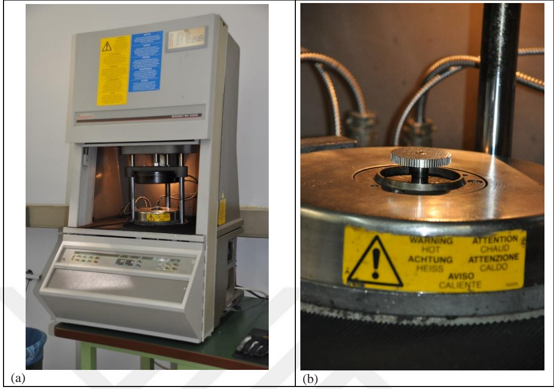
Şekil 6.8. Monsanto, MV 2000E Mooney viskozimetre ve rotor haznesi
