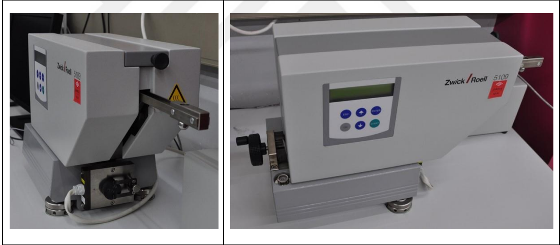
řekil 6.22. Schob sarkacılı sekme esnekliđi lm cihazı Zwick/Roell 5109
