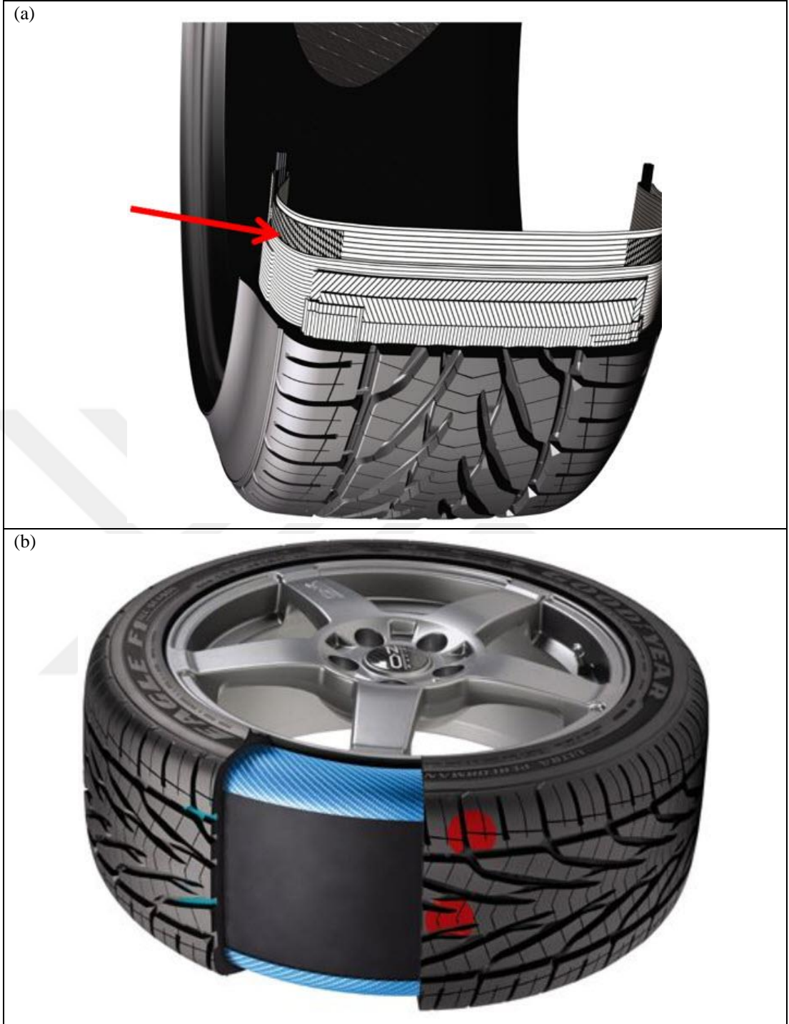
Şekil 5.53. Goodyear üretimi Eagle F1 dört mevsim lastiğinde (a) kesitte her iki yanakta karbon elyaf takviyesi (ok ile gösterilen), (b) yanakta karbon elyaf takviyesi (taralı mavi bölgeler), ultra yüksek performans için sırt merkezinde sürekli diş (İng. center rib) ve omuz blokları (İng. shoulder blocks) (kırmızı bölgeler), kar ve ıslak koşullarda çekiş sağlayan dört mevsim bölgeleri (sırtta düz mavi bölgeler) [37, 197]
