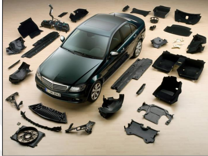
řekil 6.6. Birçoęu polimer kompozit olan araba parçaları [17]
