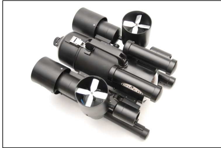
Şekil 3.2. Lucky Fin'in motorlarının konumu
