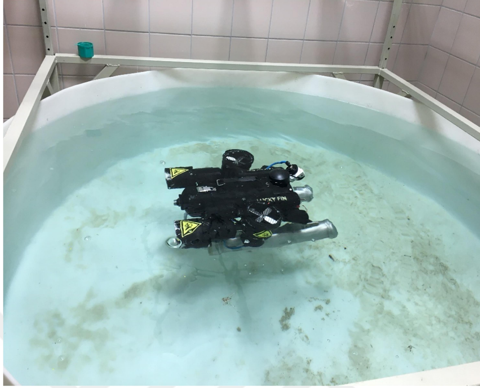
Şekil 3.19. Lucky Fin'in ileri geri öteleme testi
