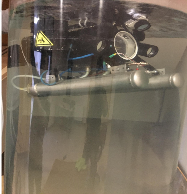
Şekil 3.12. Lucky Fin'in aşağı yukarı öteleme testleri
