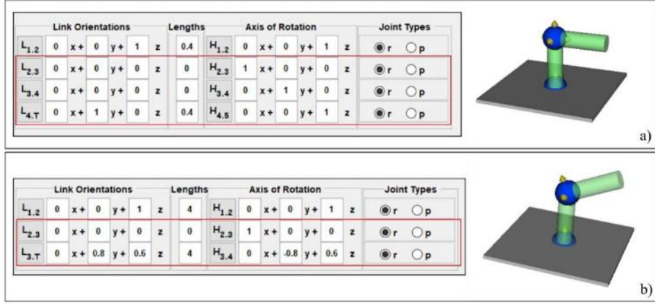
Şekil 4.6. Çok serbestlik dereceli eklem tanımları: a) küresel ve b) üniversal eklemler
