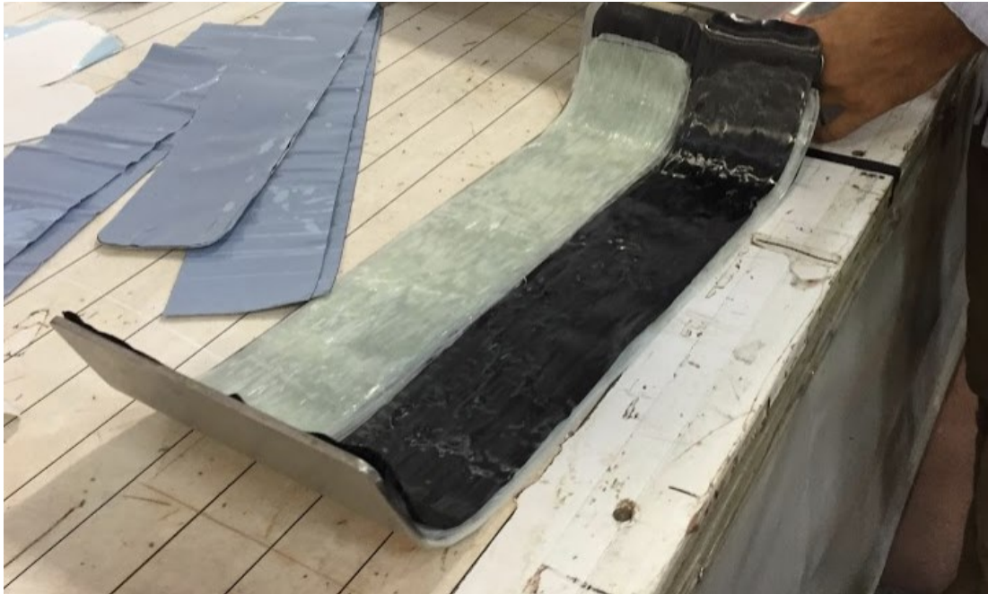
Şekil 4.26. Karbon fiber-E-Glass fiber kesilmiş katların kalıba serimi.
