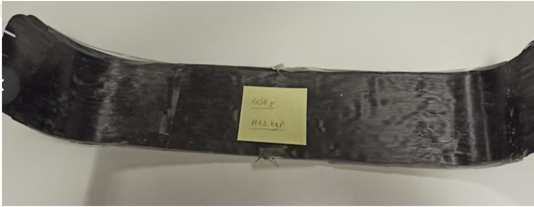
Şekil 4.27. Dowaksa karbon fiber - E-Glass fiber kürlenmiş ve test edilmiş numune.
