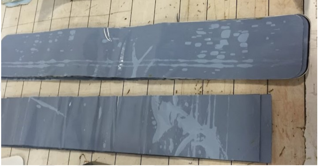
Şekil 4.16. Prepreg üzerindeki hava izlerinden oryantasyon yönü tayini
