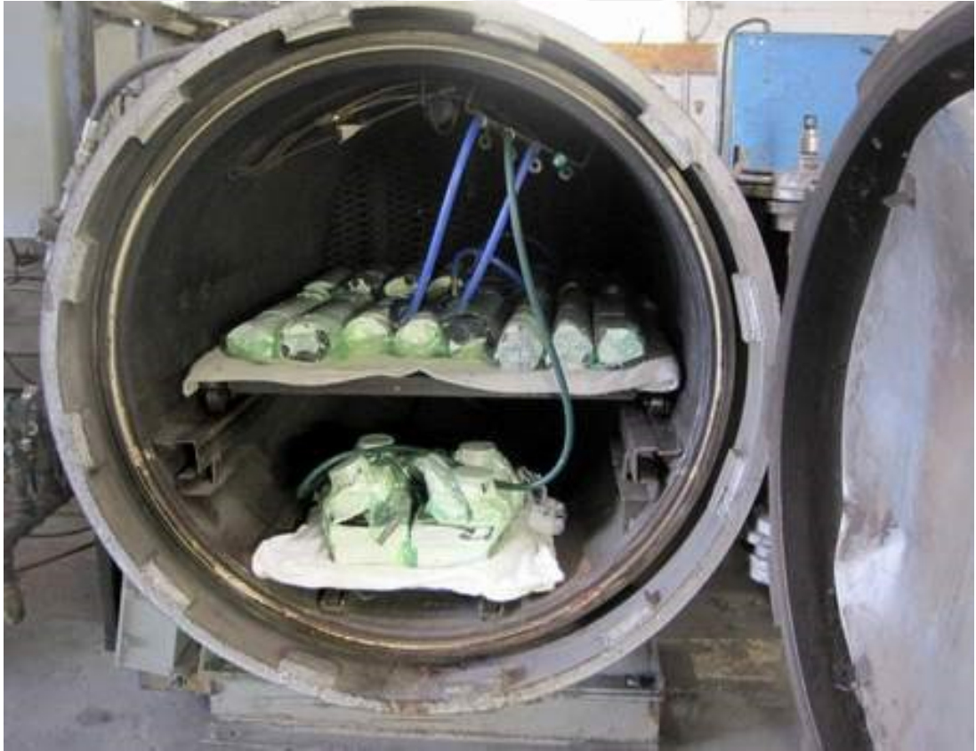
Şekil 1.15. Vakum torbalama ile hazırlanmış, otoklava yerleştirilmiş kompozit ürünler [23]
