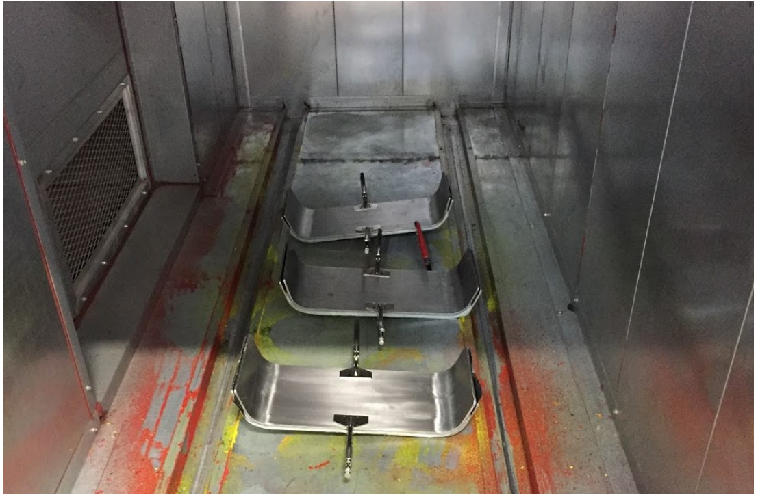
Şekil 4.17. Dowaksa karbon fiber prepreg malzemelerle hazırlanan numunelerin penslerle sıkıştırılması ve fırına konması.
