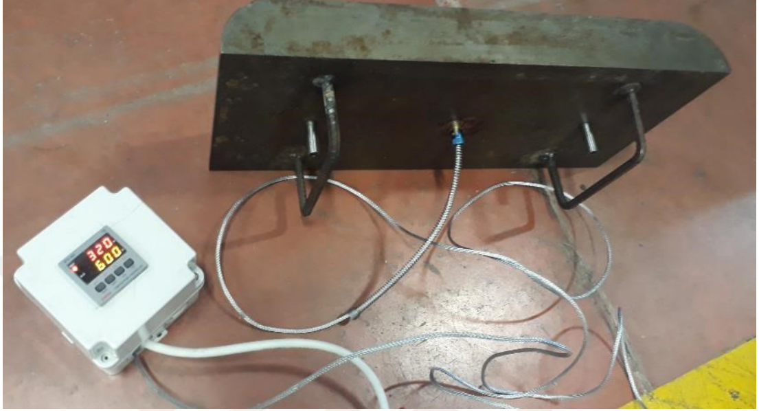
Şekil 4.7. Termokulbun kalıba montajı
