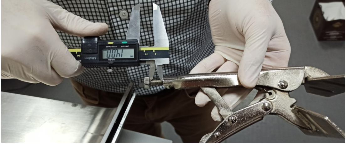
Şekil 4.23. Tüm örneklerde aynı baskıyı sağlayacak şekilde penselerin ayarlarının aynı tutulması
