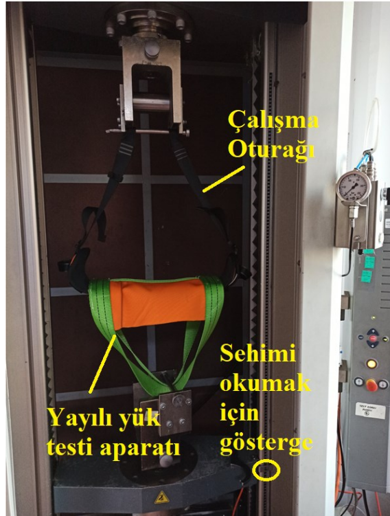
Şekil 3.2. Statik, yayılı yük ile test düzeneği
