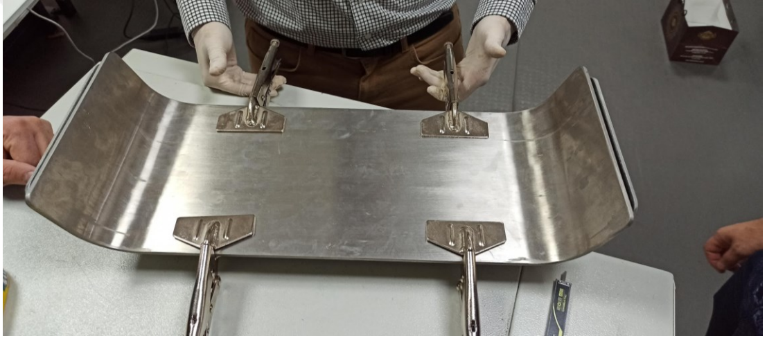
Şekil 4.24. Kalıplanması tamamlanmış yeni tip kalıp ile imalat
