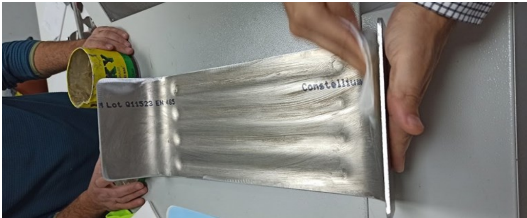
Şekil 4.19. Kalıp ayırıcı wax uygulaması
