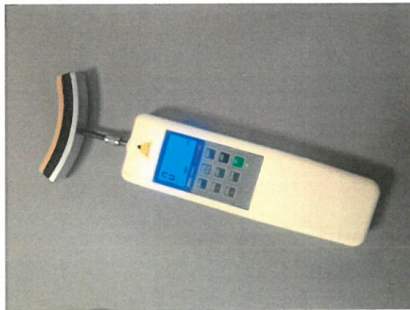
Çizim 3.12. Manuel kas ölçüm dinamometresi
