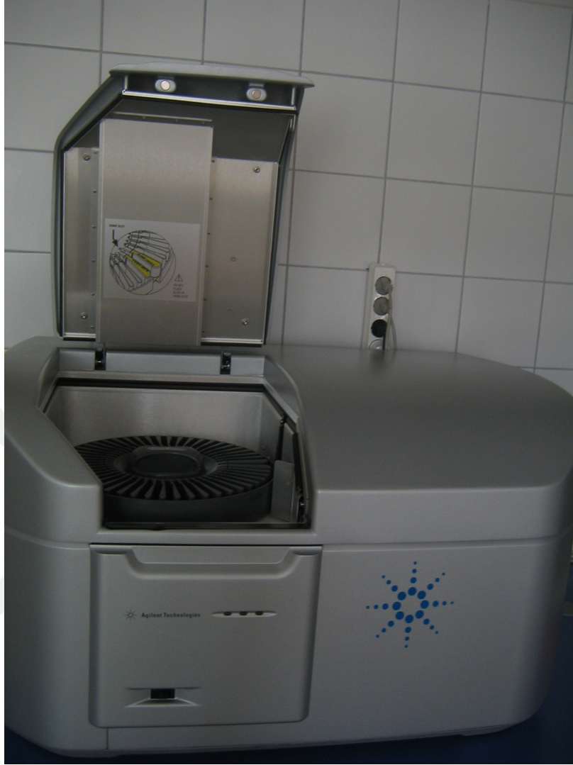
Şekil.3.5. Agilent Mikroarray Tarayıcısı G2505B Modeli
