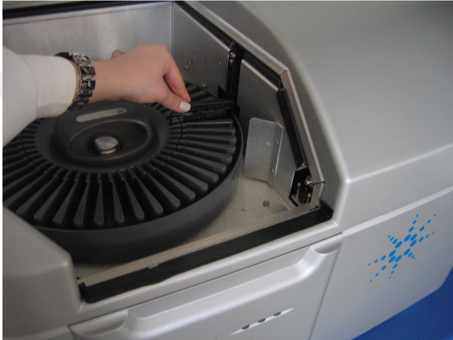
Şekil.3.4. Mikroarray taşıyan kasetlerin tarayıcıya yerleştirilmesi
