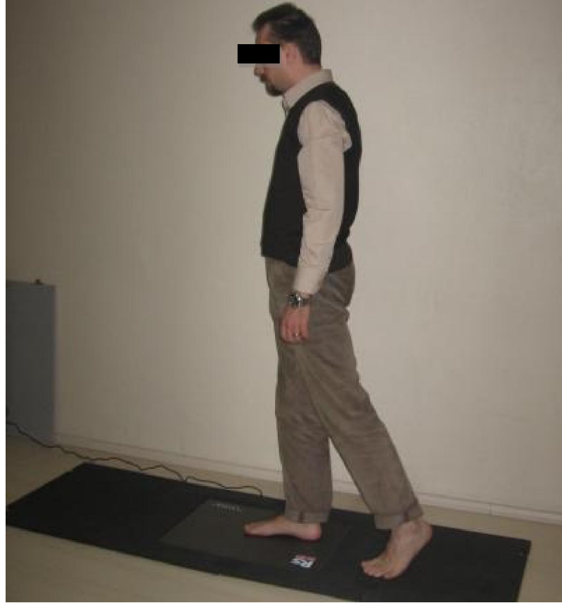
Şekil 3.18: Pedobarografi cihazı ile ölçüm yapılırken.
