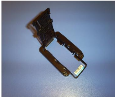
Şekil 3.4. Tarayıcı kasete yerleştirilen slayt
