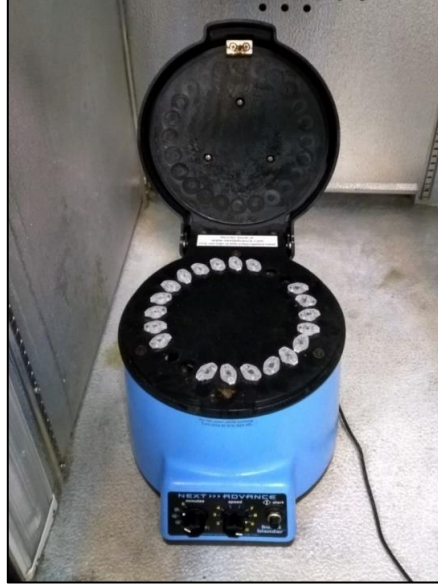
Şekil 3.3. Hücrelerin Bullet Blender cihazında +4°C’de çelik boncuklar ile parçalanması.
