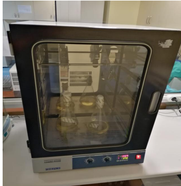
Şekil 3.2. Mikroorganizmaların flask içerisinde inkubasyonu.
