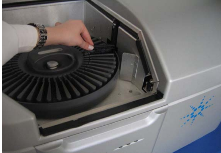
Şekil 3.5. Mikroarray taşıyan kasetlerin tarayıcıya yerleştirilmesi
