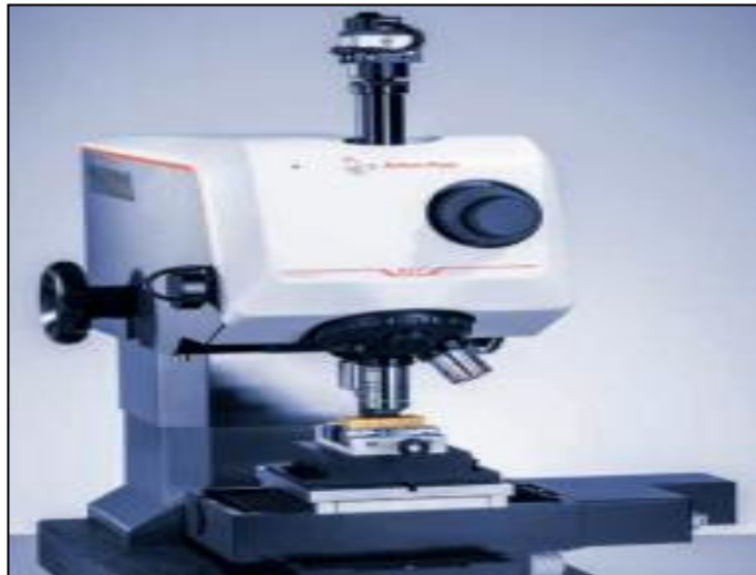
Şekil 4.11. Revetest çizik test cihazı (RST) [58]
