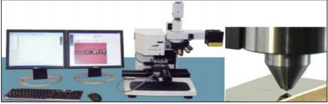
Şekil 4.5. Yüzey çizilme (Scratch) test cihazı ve Rockwell S-218 tipi batıcı uç
