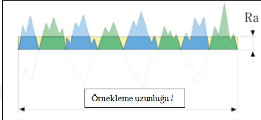
Şekil 5.2. Ra'nın gösterilmesi ve hesaplanması [66]
