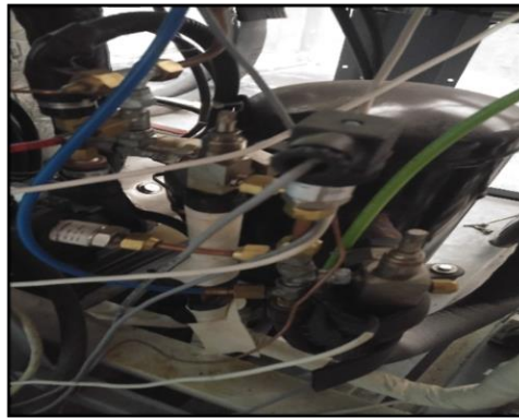
Şekil 2.15. Kompresöre monte edilmiş sıcaklık ve basınç sensörleri
