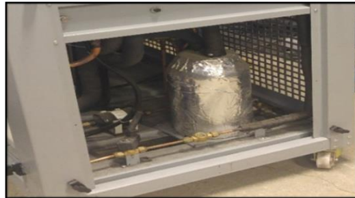
Şekil 2.6. Aşırı soğutma ve kızgınlık İİD
