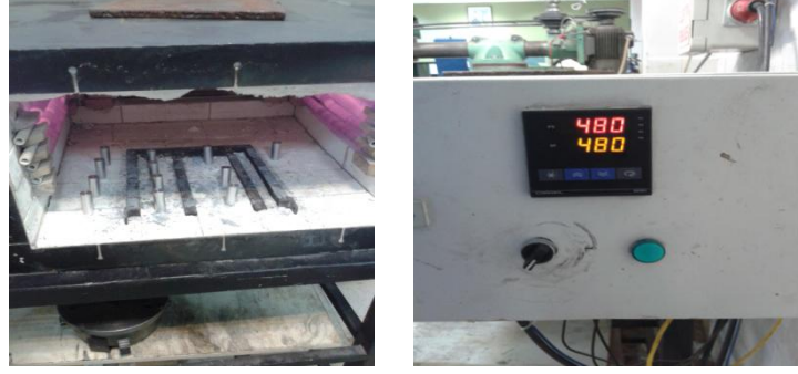
Şekil 2.1. Çalışmada homojenizasyon ısısal işlemi sırasında kullanılan (a) fırın (b) fırın sıcaklığı
