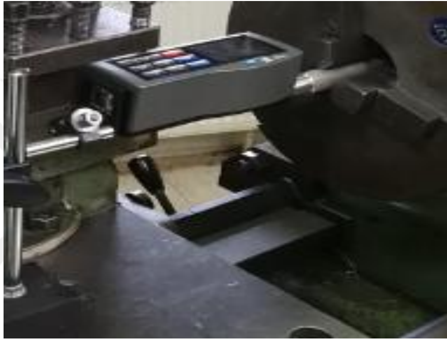
Şekil 2.8. Time TR200 profilometre
