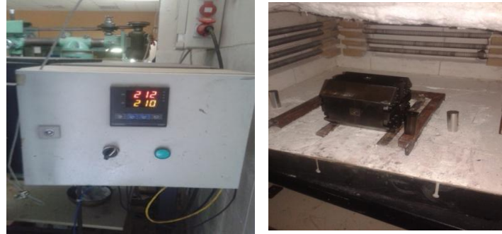
Şekil 2.2. (a) EKAP işlem sıcaklığı ve (b) ısısal işlem fırını içindeki hexa kalıp
