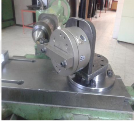
Şekil 2.5. Torna tezgahına entegre edilmiş loadcell
