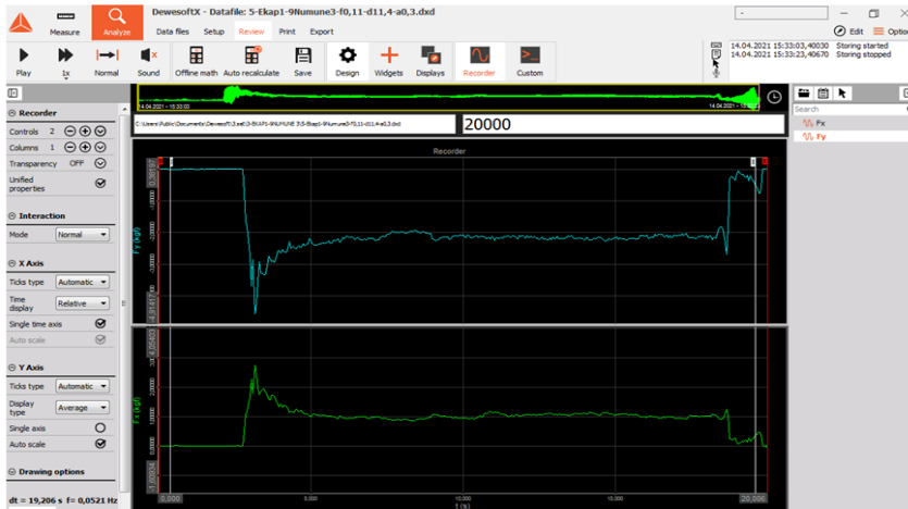
Şekil 2.7. DEWEsoft X3 yazılımı ve DEWE-43A datalogger
