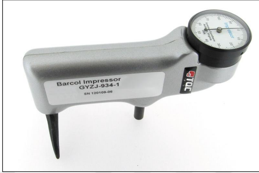
Şekil 6.2. Barcol sertlik ölçüm cihazı [76]
