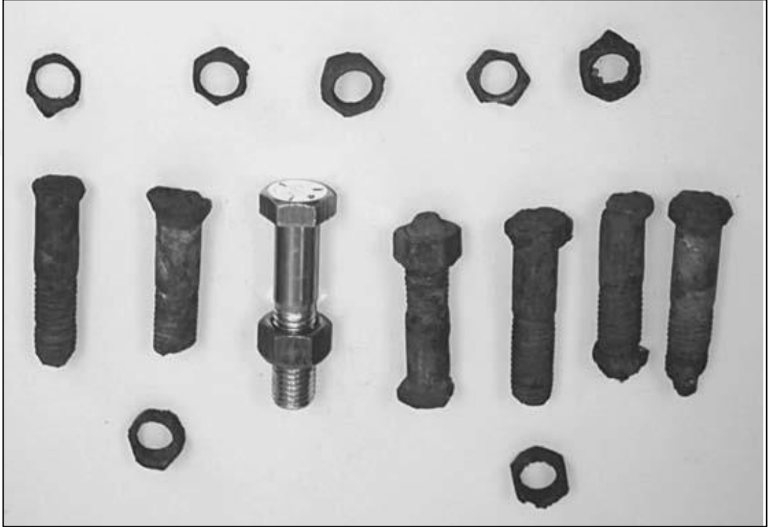
Şekil 4.5. Gerilim hücreleri nedeniyle oluşan koroziv aşınma [49]
