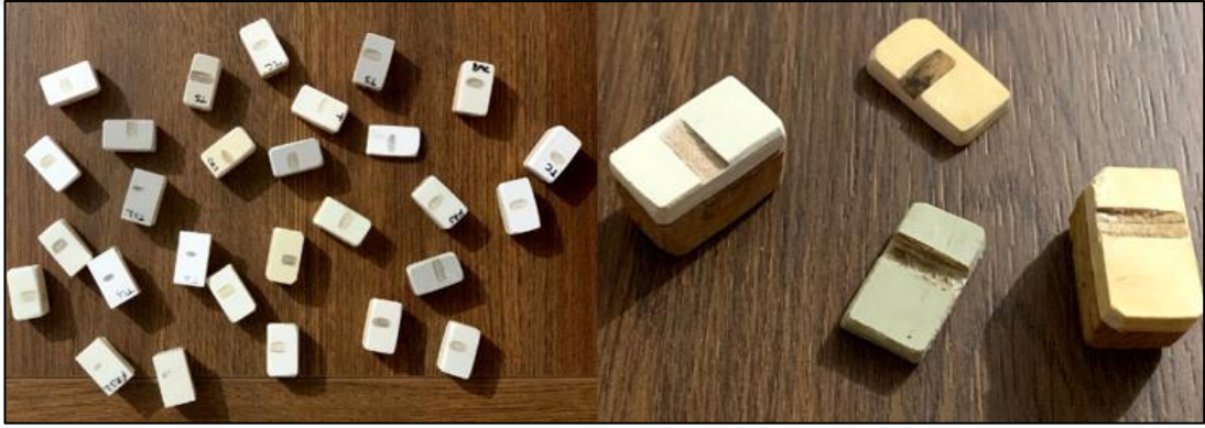
Şekil 6.10. Aşınma testi sonrası CTP numuneler
