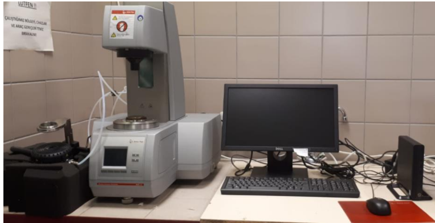
Şekil 3.6. Reometre cihazının genel görünümü
