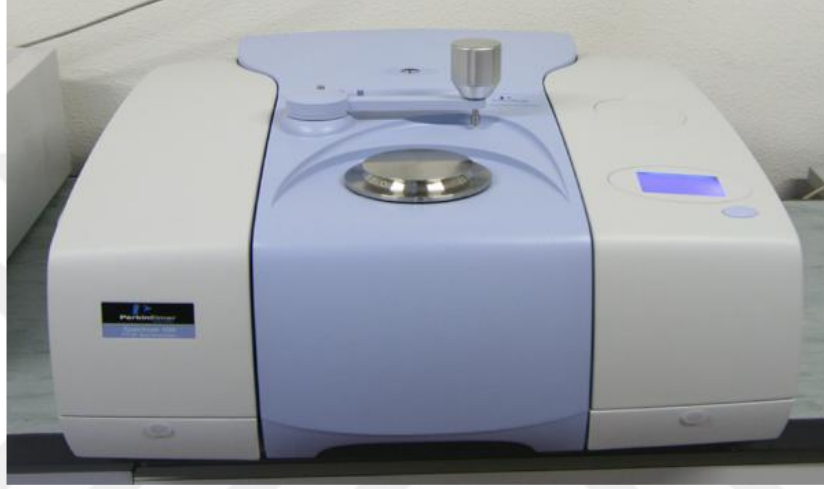
Şekil 3.4. Perkin Elmer Spectrum 100 FTIR cihazının genel görünümü
