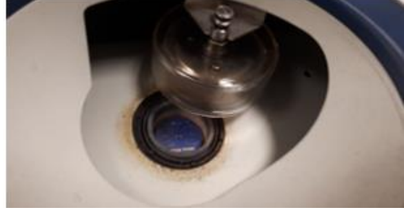
Şekil 1.18. DSC cihazının kesit alanı (Shah, 2007) ve numune/referans hazneleri
