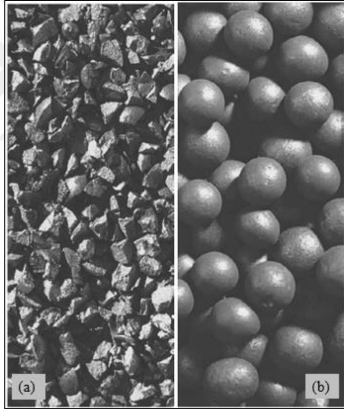
Şekil 3.1. Aşındırıcı partiküller için temel şekil tanımlamaları (a) grit ve (b) bilya [32]
