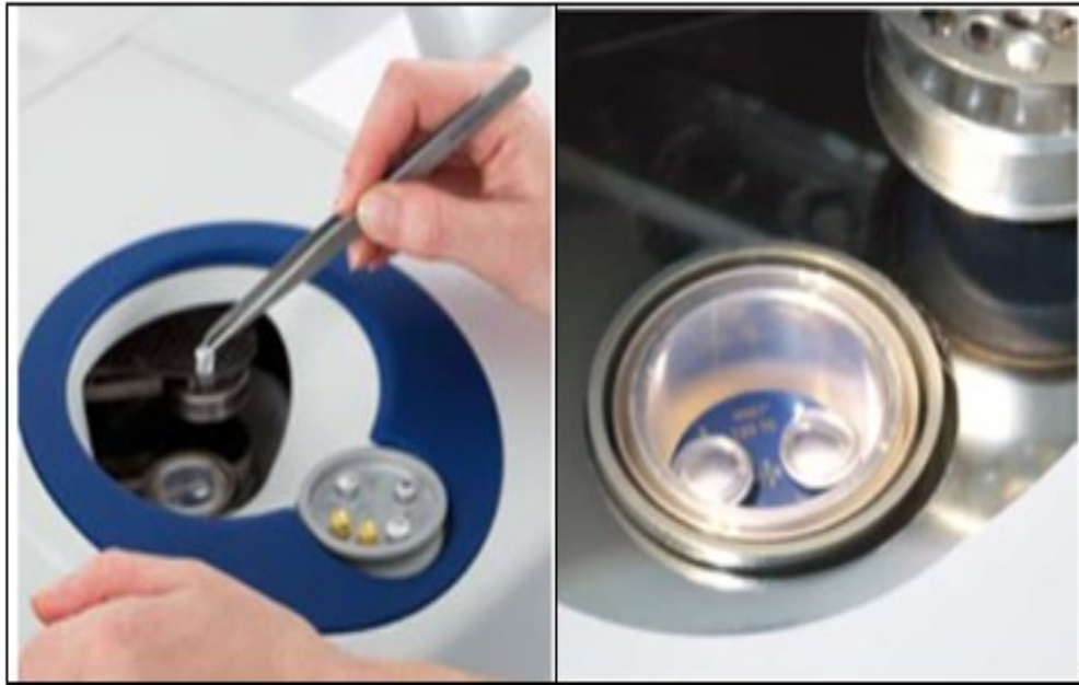
Şekil 1.18. DSC cihazı numune yerleştirme ve fırın görseli( URL-1)
