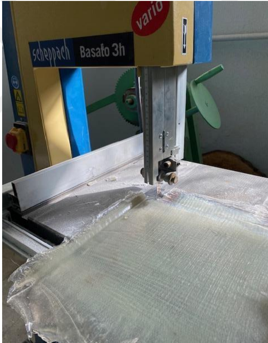
Şekil 3.3. Üretilen levhaların Scheppach marka elektrikli testere ile kesilmesi
