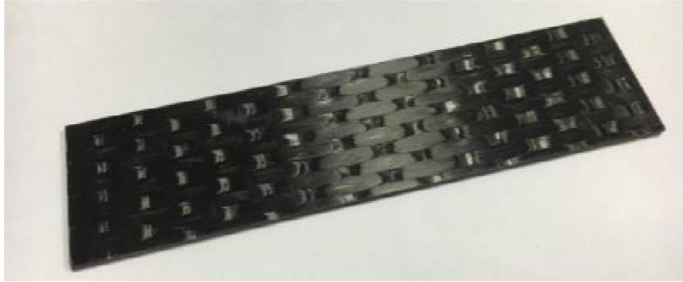
Şekil 3.1. Deneyleerde kullanılan CFRP malzemesi
