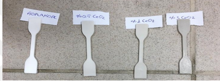
Şekil 2. 4. Enjeksiyon ile kalıplama yöntemiyle üretilmiş örnekler
