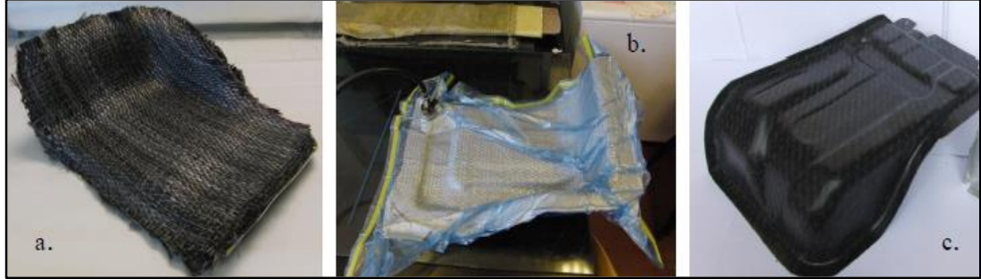
Şekil 1.25. Prototipleme adımları a) kumaş yerleştirme, b) kumaşa uygulanan vakum basıncı, c) konsolide kısım [94]
