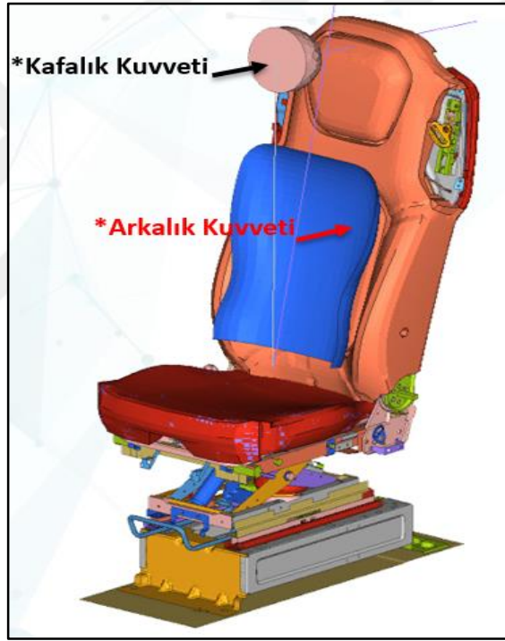
Şekil 1.6. ECE-R17 arkalık moment analizi kuvvet yükleme simülasyonu
