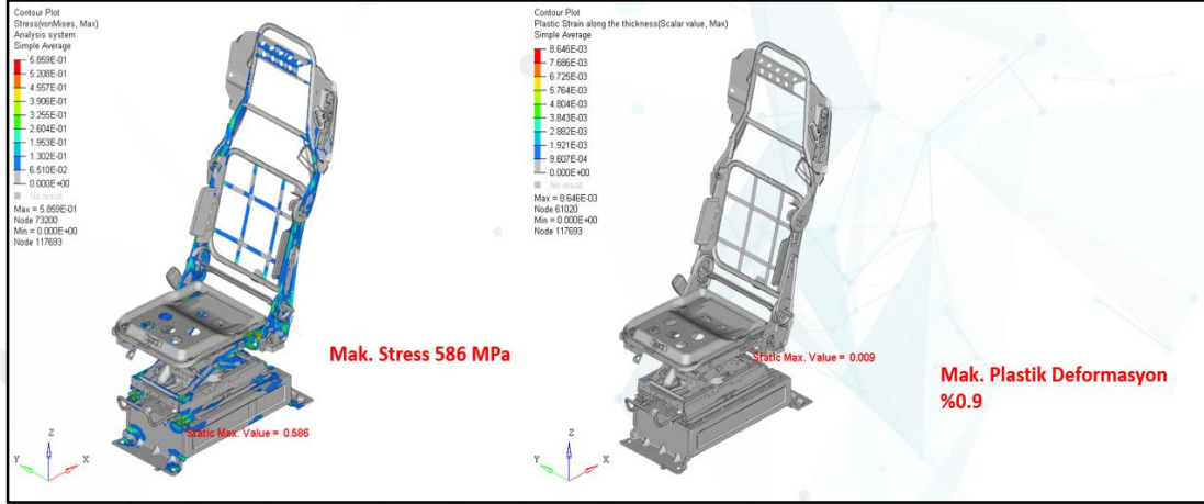
Şekil 2.15. ECE-R17 arkalık moment regülasyonu analiz sonuçları
