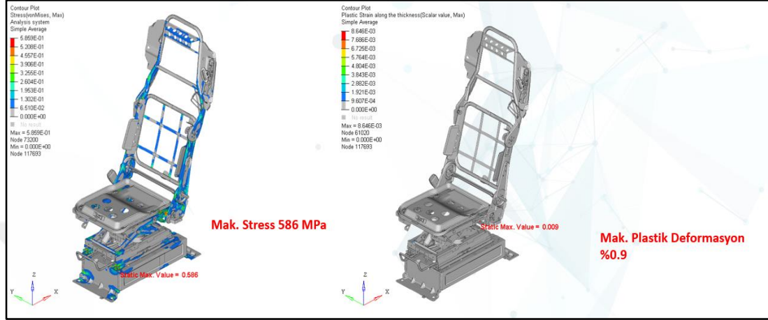
Şekil 2.17. ECE-R17 arkalık moment regülasyonu analiz sonuçları
