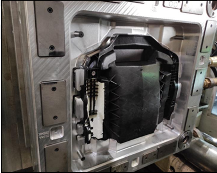
Şekil 2.5. Over-Molding prosesi sonrasında kalıptan alınmaya hazır parça görseli
