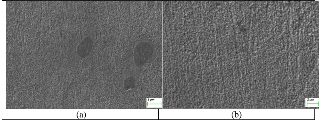
Şekil 4.11. CNS-Al alaşımının katılaşma yapısının SEM görüntüleri
