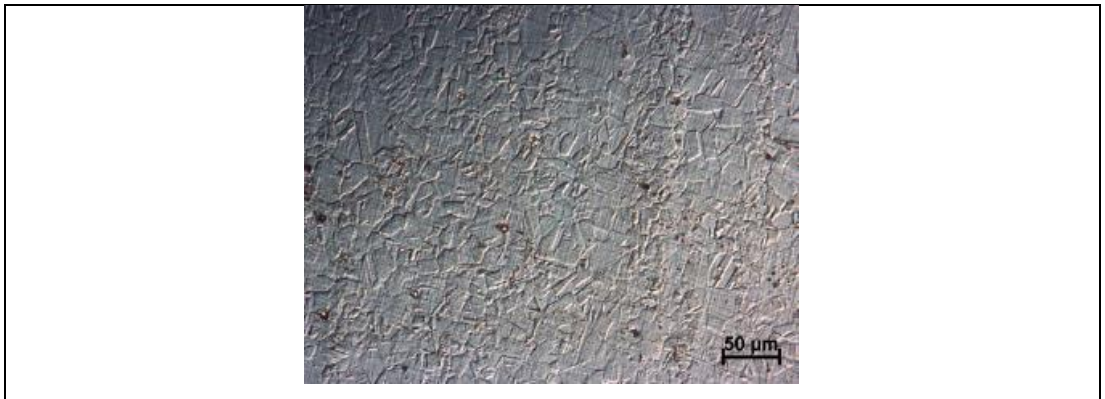
Şekil 4.1. Inconel 625 alaşımının dağlanmış matriksine ait IM görüntüsü.
