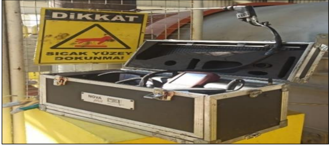
Şekil 9.7. Karbon fırınında baca gazı ölçümü
