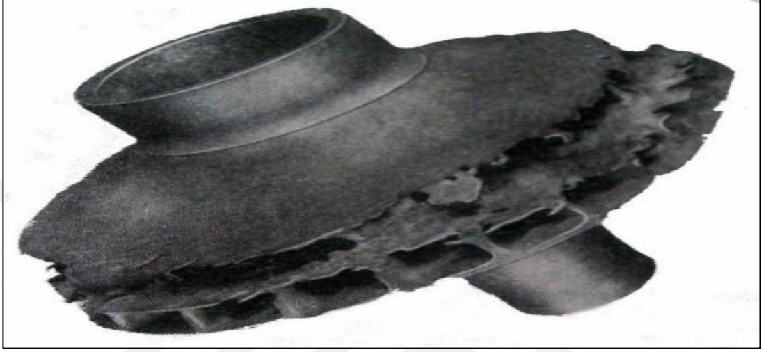
Şekil 6.5. Ekonomik ömrünü tamamlamış bir pompa çarkı örneği
