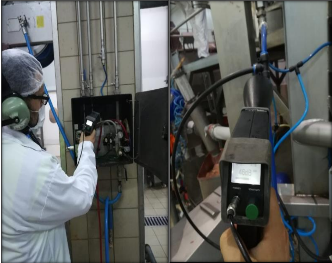
Şekil 7.8. Basıncı hava kaçaqları ölçümleri
