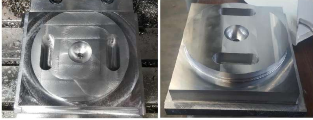
Şekil 5.44. Genel finiş işlemi (a) öncesi (b) sonrası
