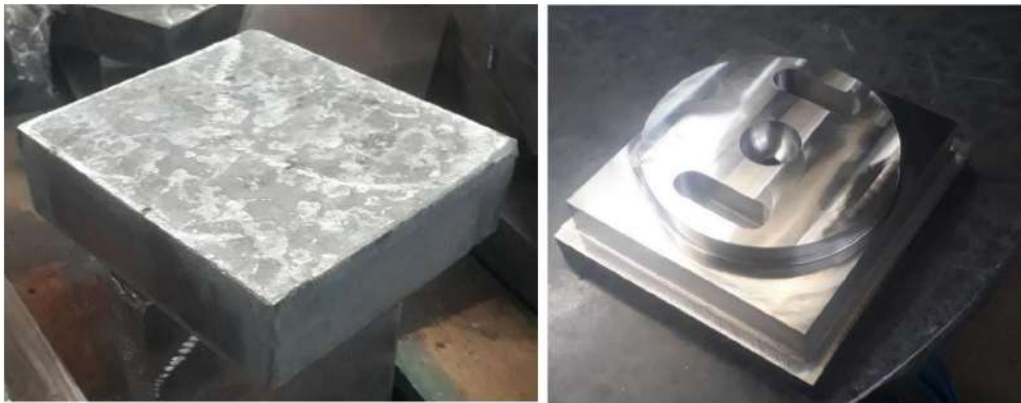
Şekil 5.25. (a) İşlenecek kütük parça (b) işlenmiş parça
