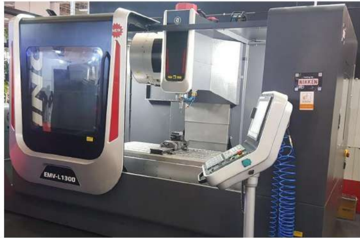
Şekil 5.22. 3-Eksen CNC-Freze tezgâhı giydirilmiş versiyonu
