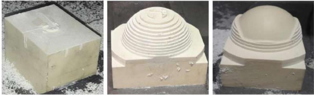
Şekil 5.60. (a) Kütük parça (b) kaba işleme ürün çıktısı (c) finiş işleme ürün çıktısı
