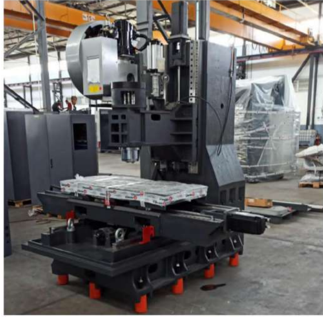
Şekil 5.21. 3-Eksen CNC-Freze tezgâhı açık versiyonu
