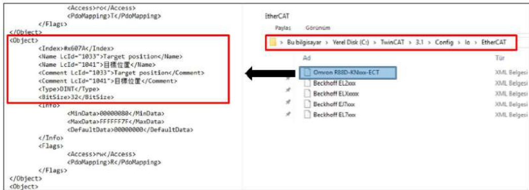
Şekil 4.21. Servo sürücüsüne ait XML dosyasının TwinCat yazılımına eklenmesi
