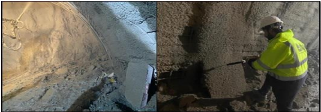
Şekil 4.16. Püskürtme betondan panel numune alınması ve penetrometre testi
