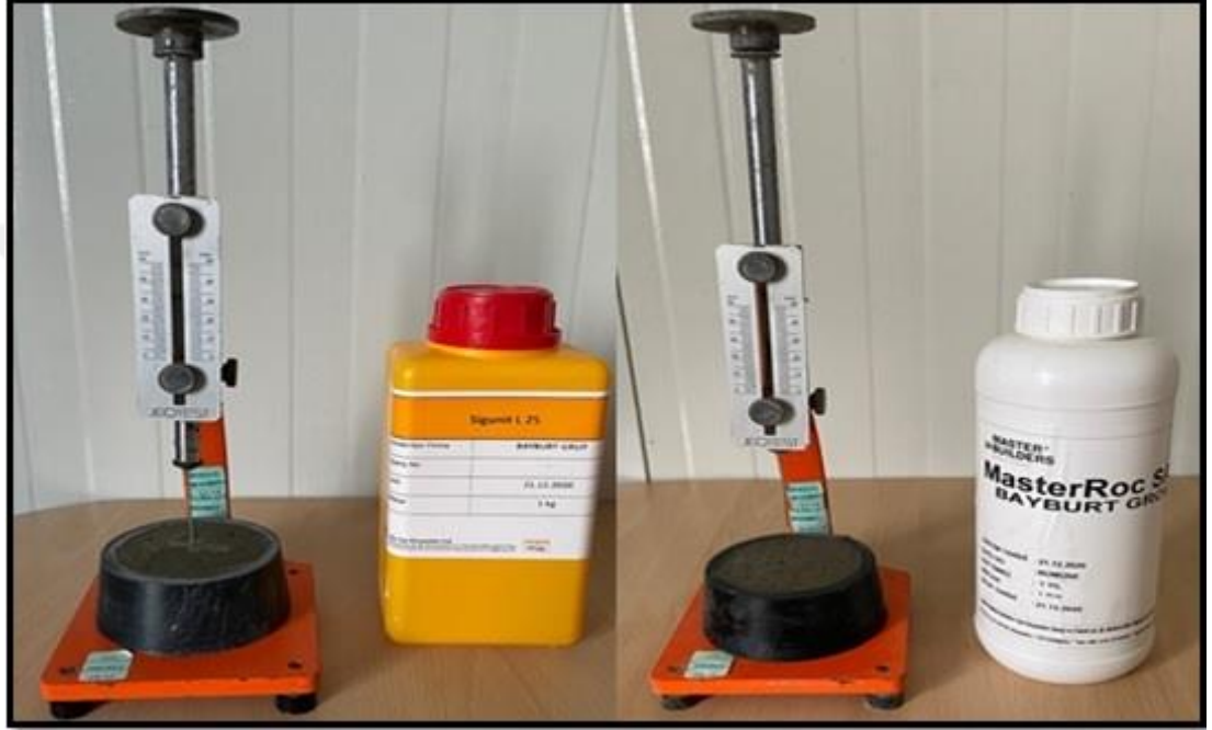
Şekil 2.18. Vikat deneyi ile alkali ve alkali olmayan katkı priz süresinin karşılaştırılması
