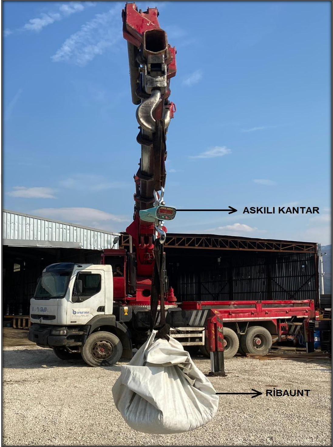
Şekil 4.14. T-1 tasarımına ait geri seken beton miktarının toplanıp tartılması
