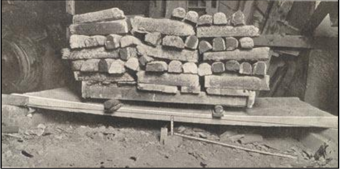
Şekil 1.4. Lehigh Üniversitesi'nden Profesör M. O. Fuller'ın gözetiminde yapılan gunite plakalarının testi
