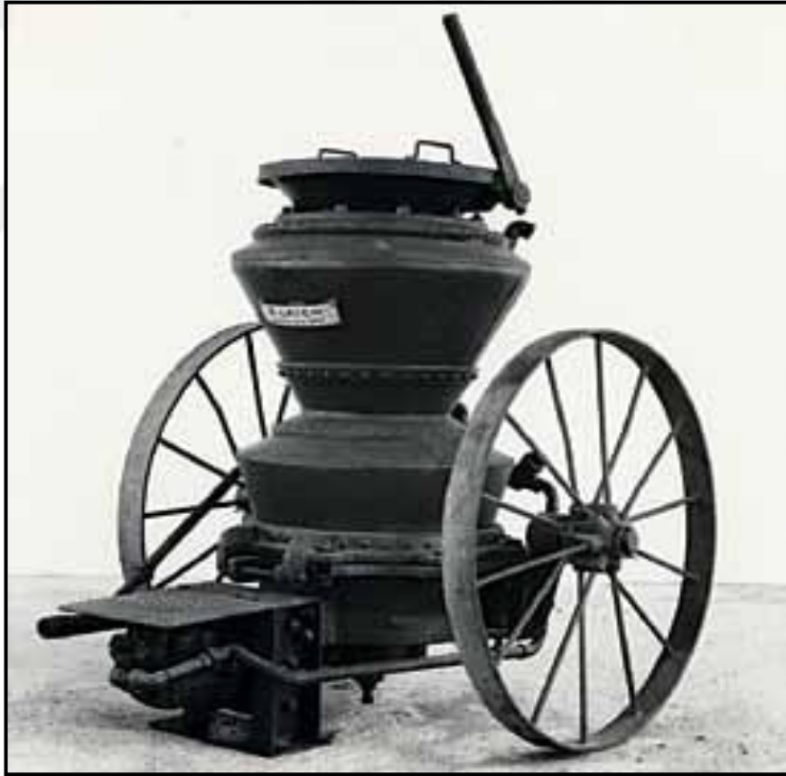
Şekil 1.5. Cement Gun firmasının 1914'te geliştirdiği çift odacıklı püskürtme beton makinesi (Teichert, 2003)
