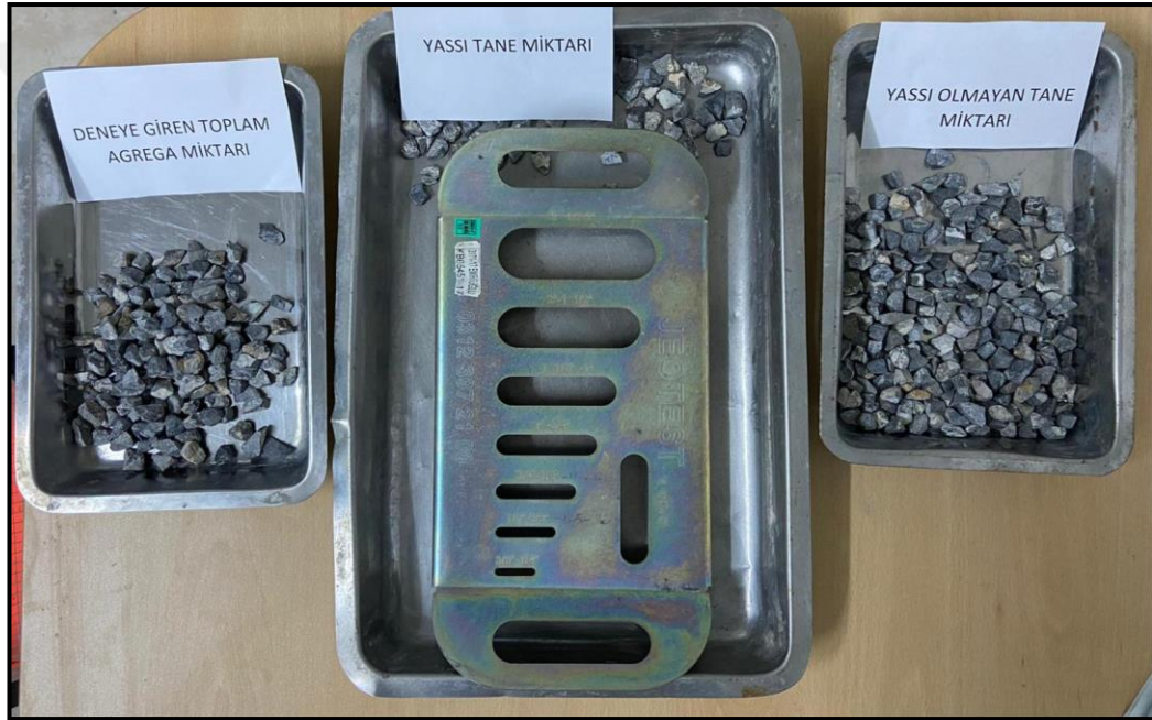
Şekil 4.4. Dolomit agregasında yapılan yassılık indeksi deneyi
