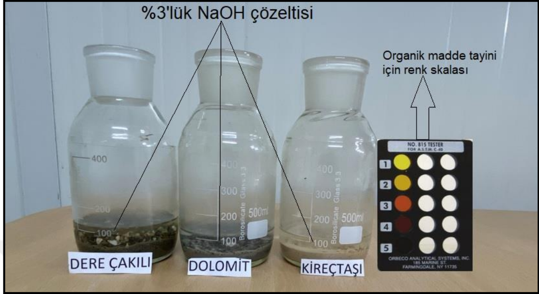
Şekil 4.9. Kırmataş agregalarına ait organik madde deneyi
