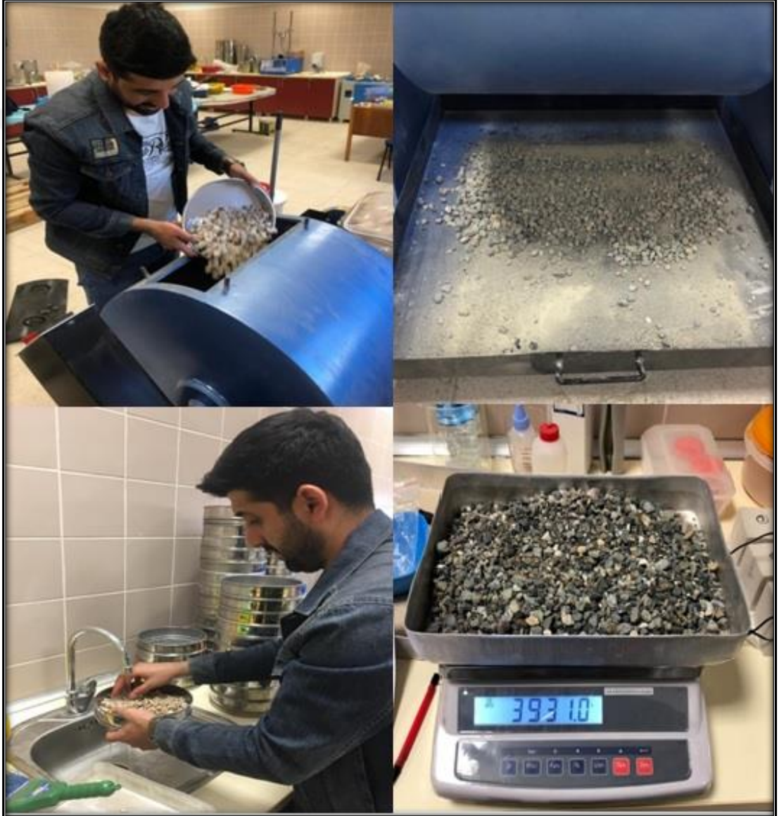
Şekil 4.5. Los Angeles aşınma deneyi aşamaları
