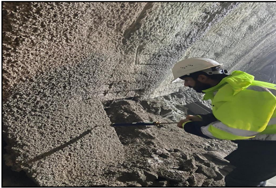
Şekil 2.22. Püskürtme betonda proktor penetrometre testi
