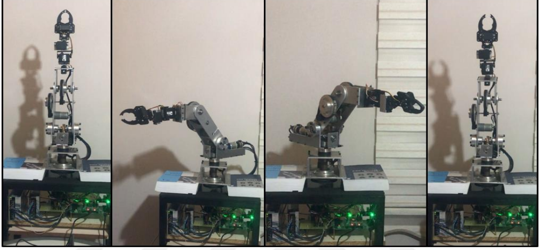
Şekil 6.7. Altı eklemin doğrudan veri ile eş zamanlı çalıştırılması
