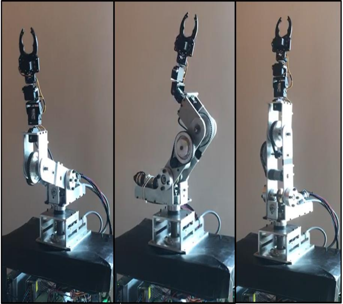
Şekil 6.21. Ters kinematik model kullanılarak yörünge takibi / çalışma-2
