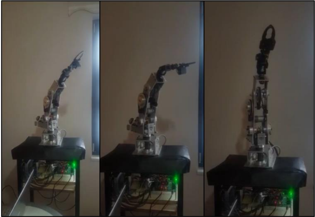
Şekil 6.11. İleri kinematik model kullanılarak yörünge takibi / çalışma-1 (a)t=2 anındaki görüntü (b) t=5 anındaki görüntü (c) t=10 anındaki görüntü
