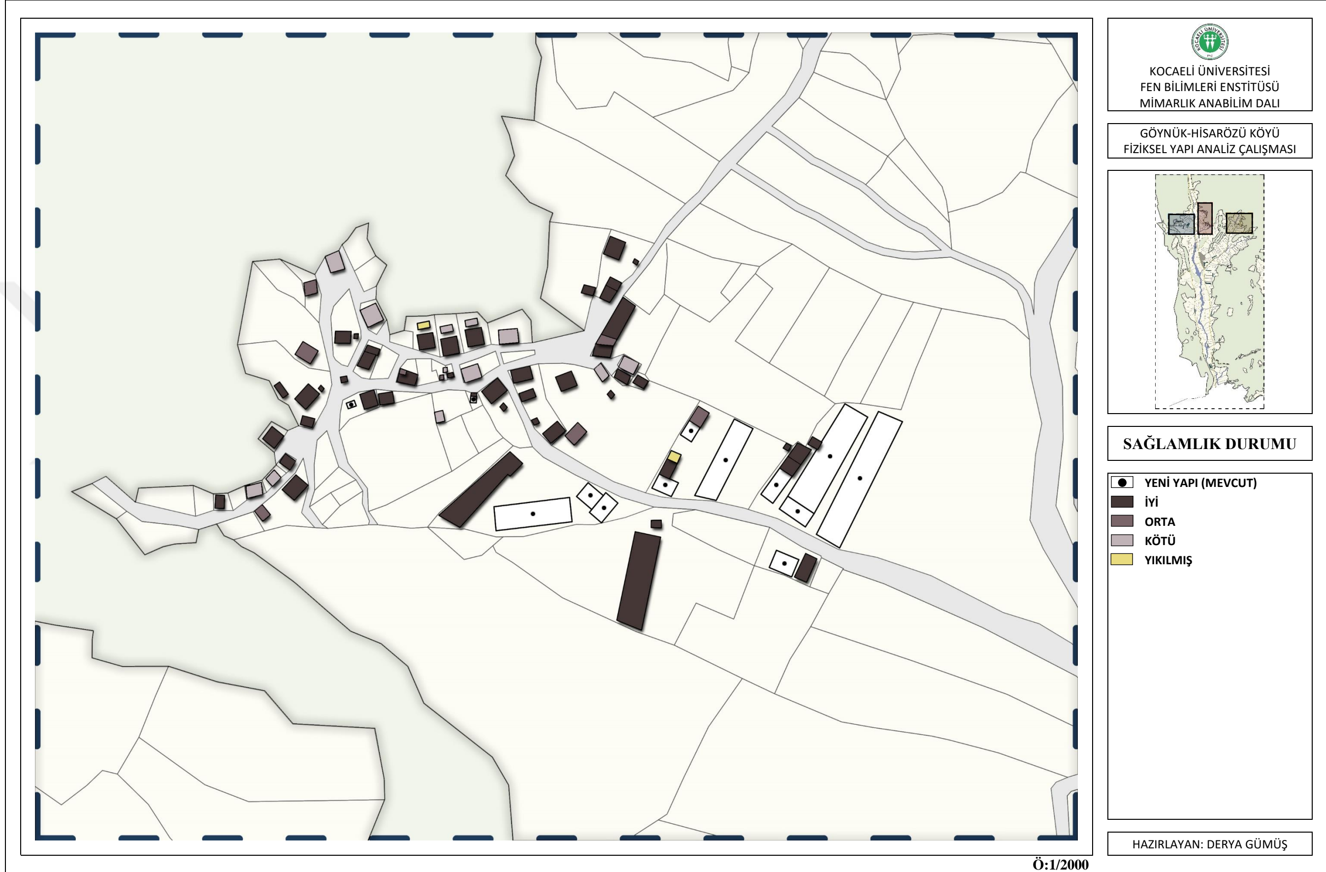
Şekil F.10. Hisarözü Köyü-Merkez Mahallesi yapı sağlamlık durumu analizi (Gümüş Yıldırım, 2020)
