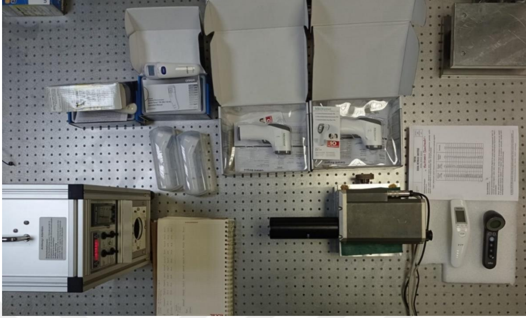
Şekil 2.24. ME30 model kaynağın kararlılık kontrol düzeneği ve tez kapsamında kullanılan alın termometreleri
