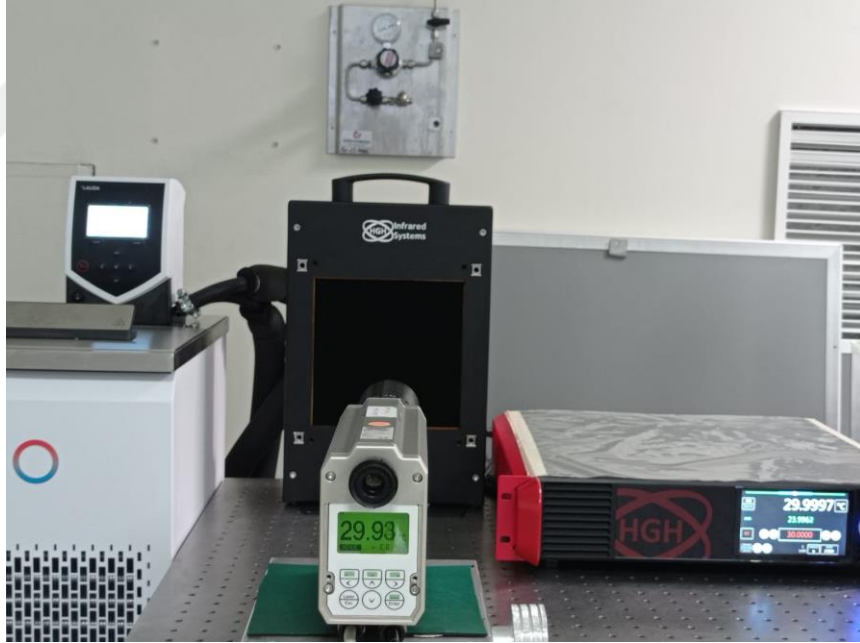
Şekil 2.14. HGH kaynağının ışımasının Heitronics marka pirometre ile ölçümü düzeneği
