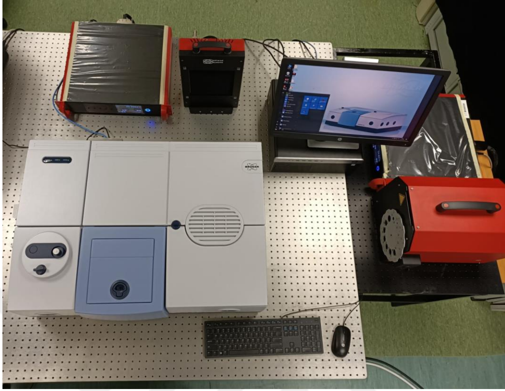
Şekil 2.3. TÜBİTAK-UME Termodinamik Metroloji Laboratuvarı Bünyesinde Kurulan FT-IR Spektrometre ile Emisivite Ölçüm Sistemi
