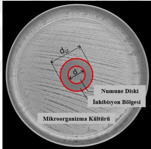
Şekil 5.3. Antimikrobiyal inhibisyon bölgesi ölçümleri. İnhibisyon bölge ( d_{iz} ) çapı ve disk çapı ( d ) ile gösterilmiştir (Martí ve diğ., 2018)
