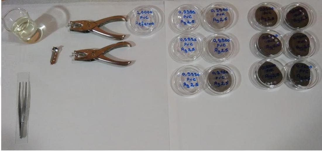
Şekil 4.7. Agar disk difüzyon testi ve TEM incelemeleri için Ø6 mm disklerin eldesi
