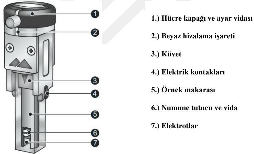
Şekil 4.11. Katı numunelerden zeta potansiyeli ölçümü alınmasına izin veren ZEN1020 daldırma hücresi (Malvern, 2013)
