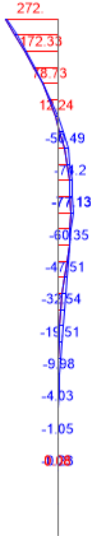
Şekil 4.21. Yöntem III sonucu kritik kazık moment diyagramı (kNm) (Y yönü)
