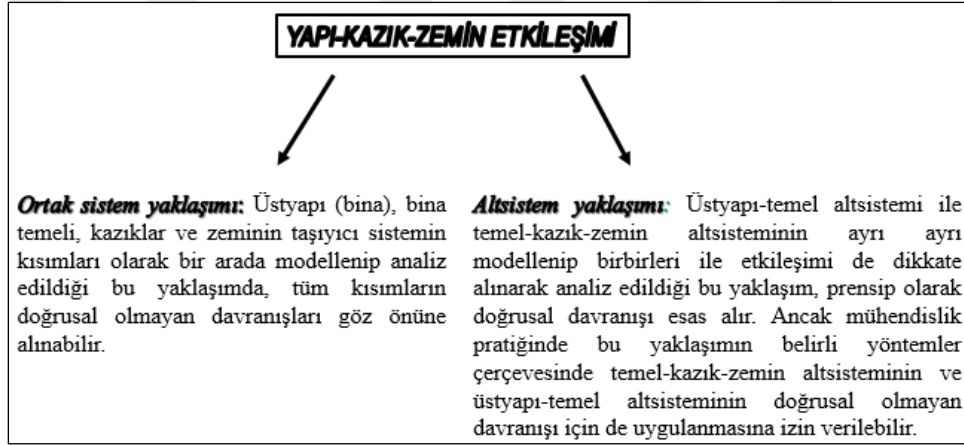
Şekil 3.1. Yapı-kazık-zemin etkileşimi yaklaşımları
