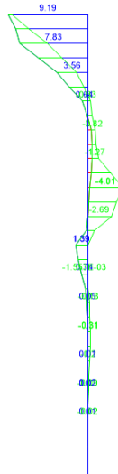
Şekil 4.56. Kinematik etkileşim sonucu kritik kazık moment diyagramı (kNm) (X yönü)
