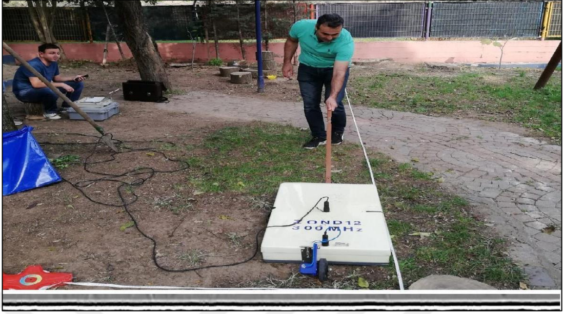
Şekil 2.8. Yer radarı yönteminin arazide uygulanişı
