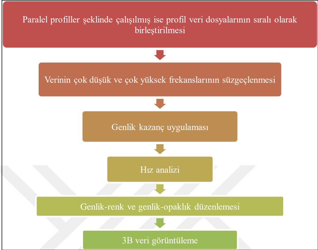
Şekil 2.17. Yer radarı verilerine uygulanan veri-işlem akış şeması (Kadioğlu, 2003)
