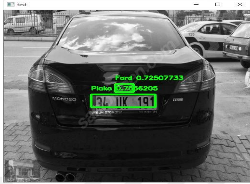
Şekil 5.10. Resim Üzerinde Araç ve Plakanın Bulunması (a)
