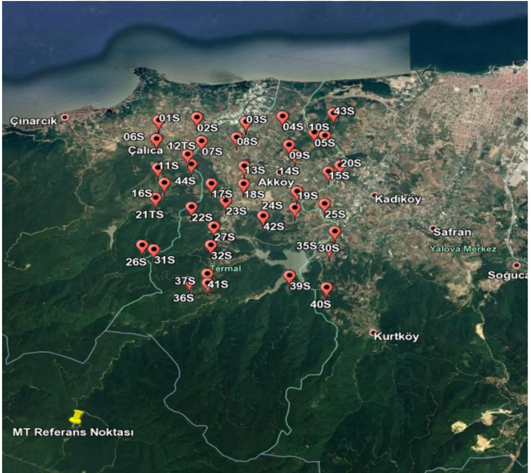
Şekil 4.1. Manyetotellürik ölçü noktaları. Referans istasyonun kendisine en yakın olan 36S istasyonuna olan uzaklığı yaklaşık 5,5 km’dir.
