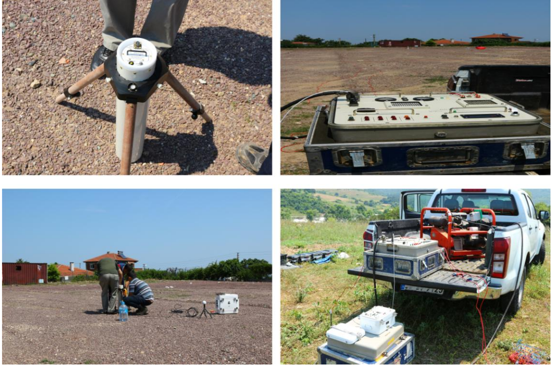
Şekil 3.1. TEM verilerinin toplanması için yapılan saha çalışması.
