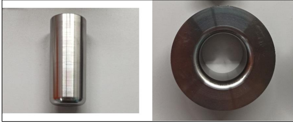
Şekil 3.5. İmalatı gerçekleştirilmiş zımba ve dişi kalıp
