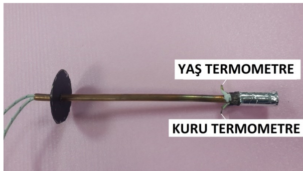
Şekil 2.16. Yaş-kuru termometre sıcaklık ölçüm sensörlerini taşıyan prop
