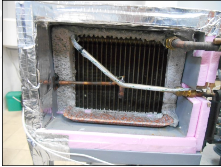
Şekil 2.7. İç ünite hava kanalı çıkışı ve yaş kuru termometre sensörlerinin konumu
