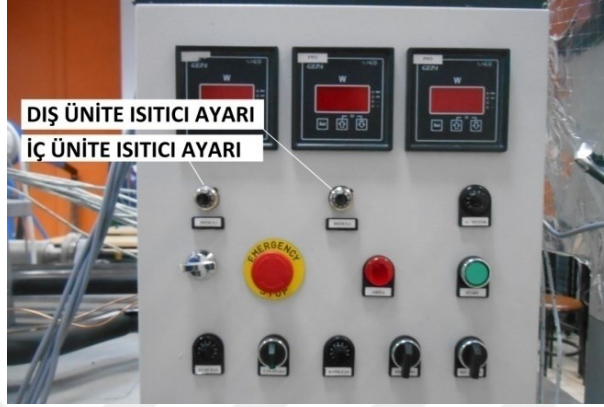
Şekil 2.12. Kontrol panosu ve ısı yük ayar potansiyometreleri
