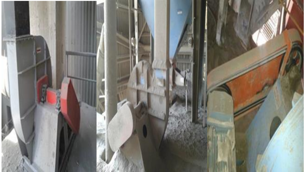
Şekil 5.3. 3 ve 4 nolu çimento değirmenleri toz toplama fanları
