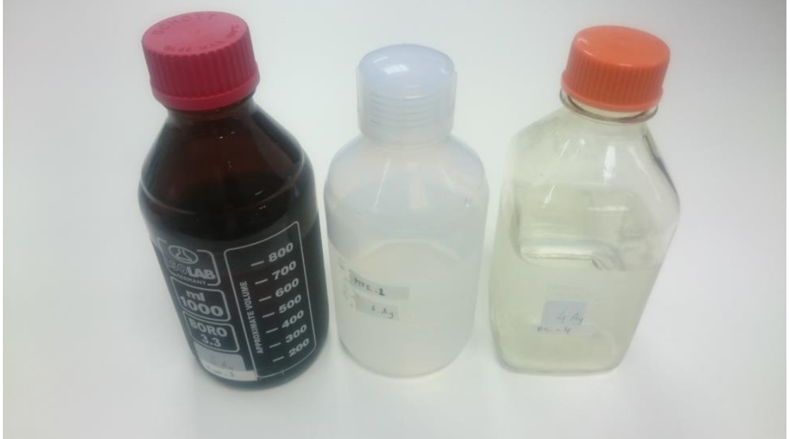
Şekil 3. 39. Test edilen amber cam, teflon ve polikarbonat şişeler
