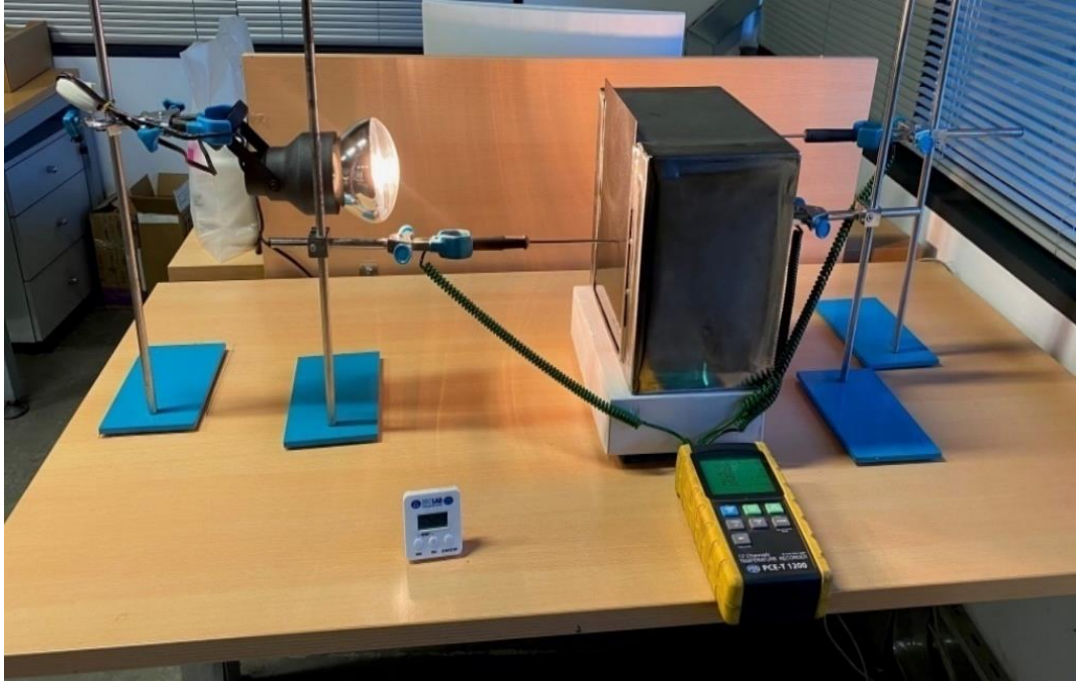
Şekil 2.2. IR lamba etkisinde sıcaklık artışı tayini düzeneği
