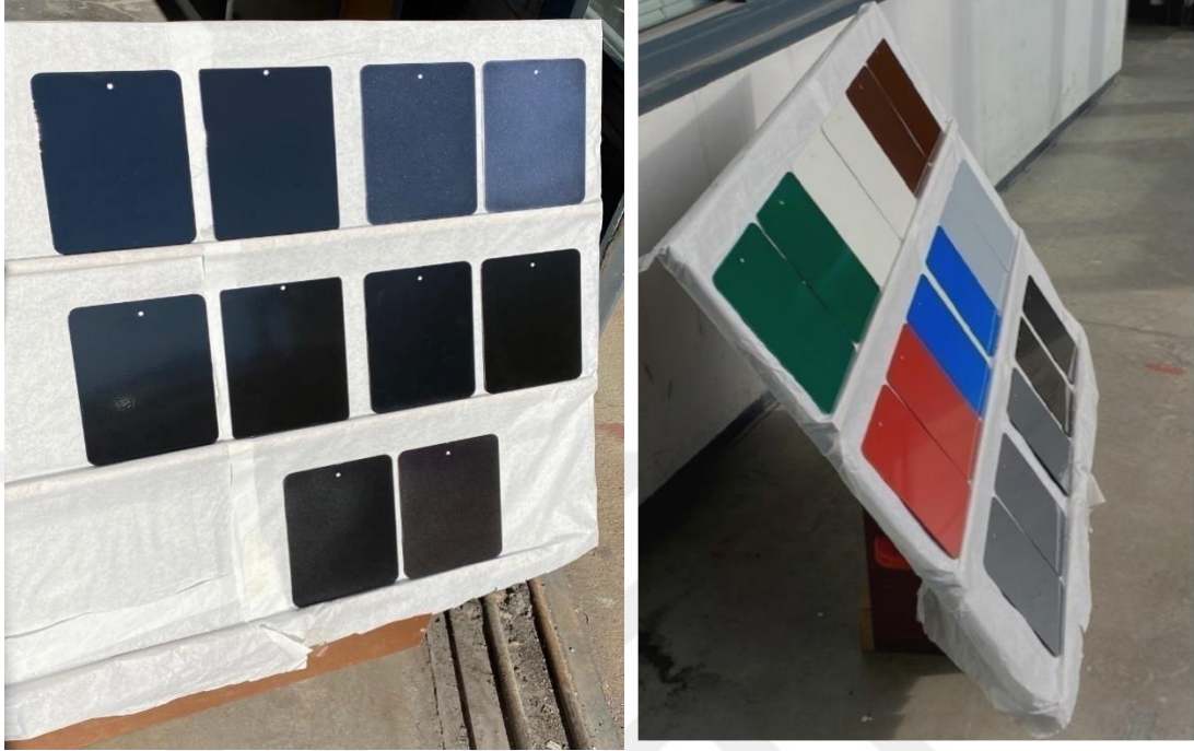
Şekil 2.3. Güneş Işığı Etkisinde Yüzey Sıcaklığı Ölçüm Düzenegi
